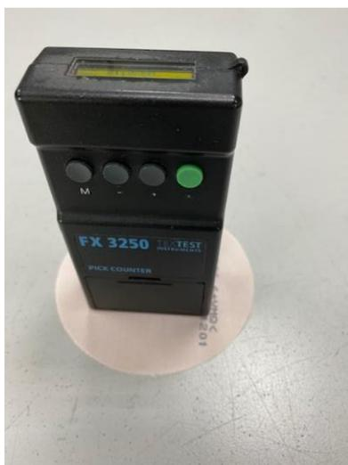
Figura 12: Execução do ensaio da densidade linear.
