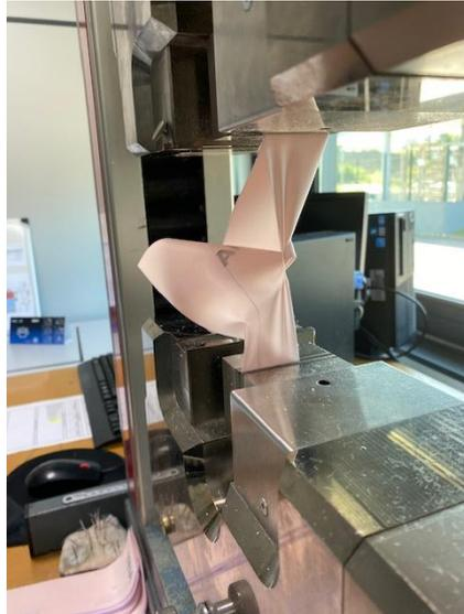
Figura 16: Colocação do provete na máquina de tração.
