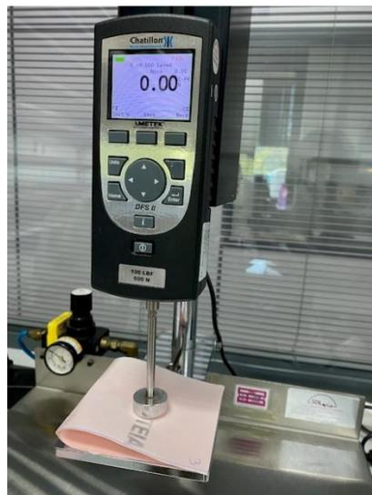
*Figura 18: Colocação do provete no dinamómetro, para a posterior execução do ensaio.*
