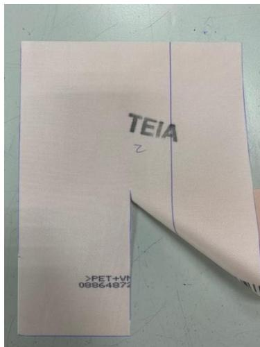
*Figura 15: Corte do provete para efetuar o ensaio da força de rasgo.*
