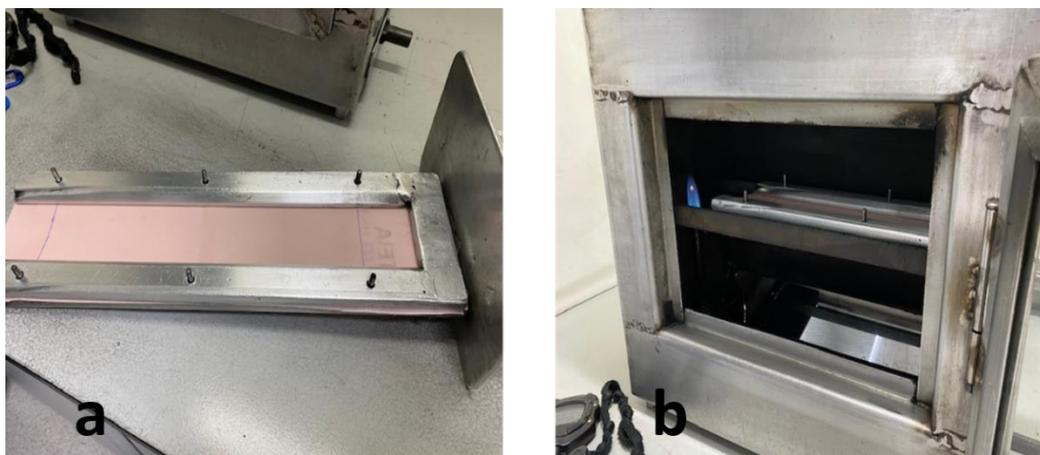
Figura 10: a) Provete a ser inserido no suporte da câmara de inflamabilidade. b) Suporte a ser colocado no interior da câmara de inflamabilidade e ativação da chama.
