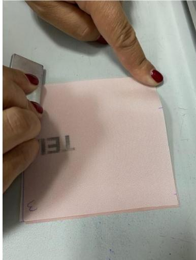
*Figura 17: Vincar o provete para a realização do ensaio da rigidez.*
