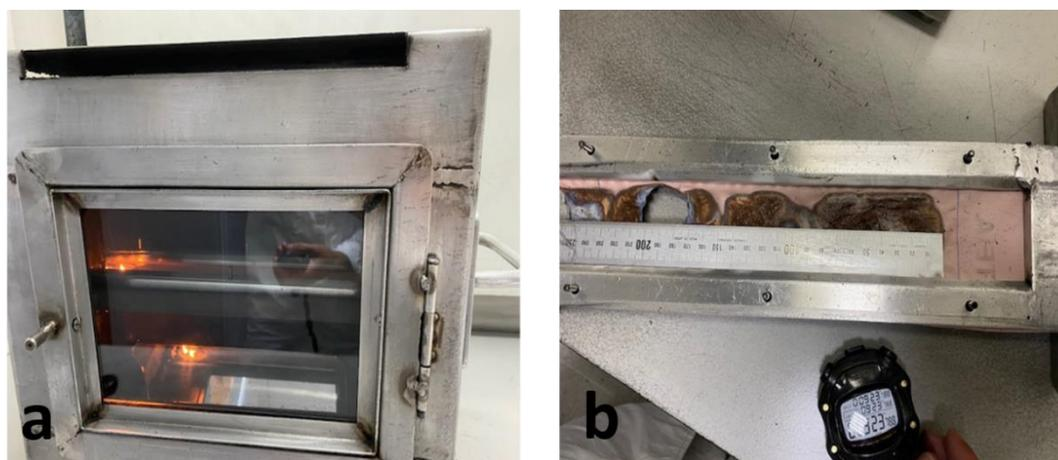
Figura 11: a) Execução do ensaio de inflamabilidade. b) Registo da distância queimada e do tempo de queima.
