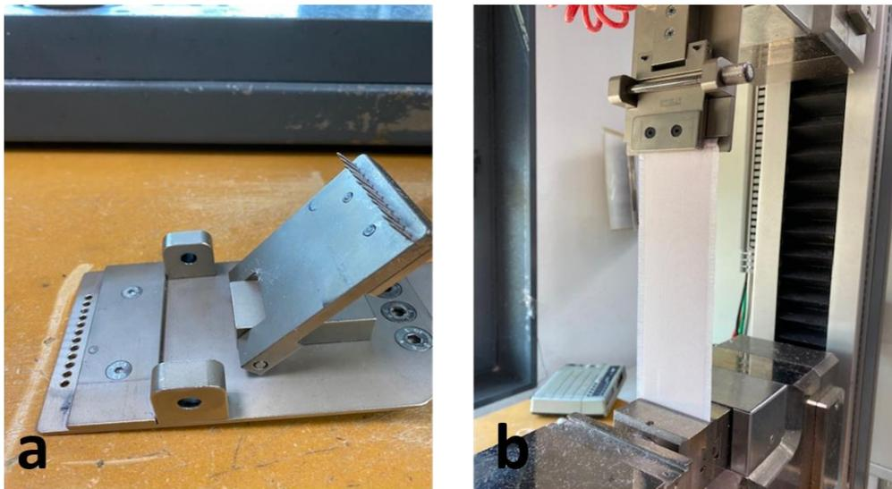
Figura 13: a) Acessório de *edgecomb*. b) Colocação do provete para execução do ensaio de *edgecomb*.
