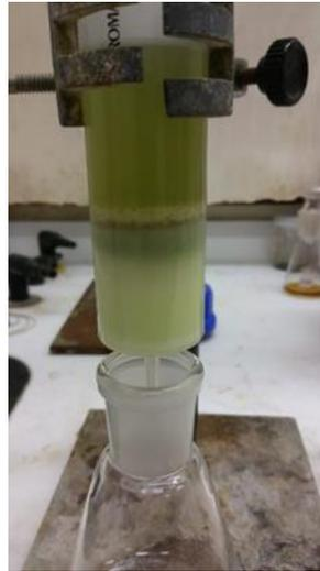
Figura 32 – Extração de clorofilas utilizando numa Chromabond C18<sup>®</sup> em que se visualiza a separação dos componentes do extrato ao longo da sílica.
