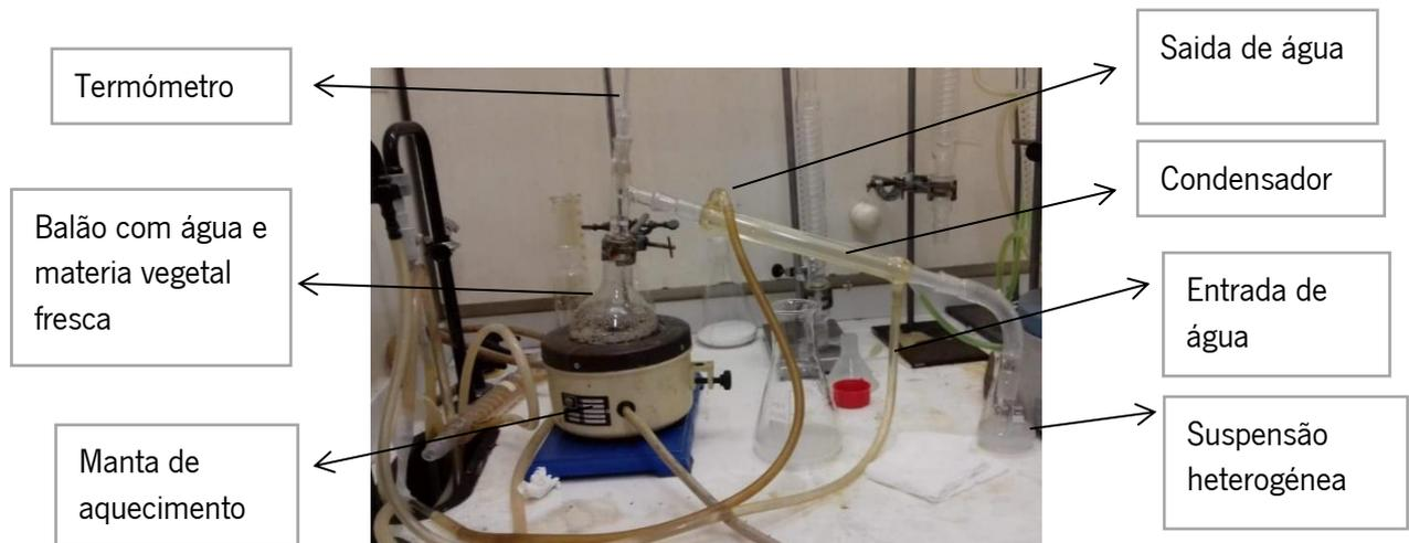
Figura 30 – Montagem e equipamento do hidrodestilador.
