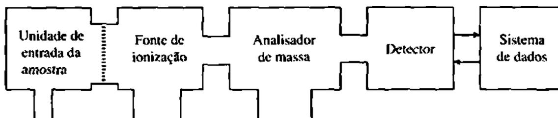
Figura 44 – Componentes do espetrómetro de massa. (adaptado de Pavia, D., L. & et al., 2010)<sup>113</sup>
