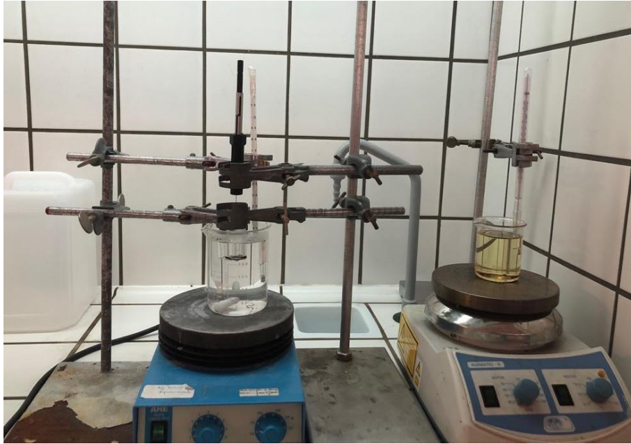
Figura 23 - Na primeira placa de aquecimento mostra a resina V70 durante o processo de extração mergulhada no banho-maria de água, a segunda placa tem a parafina a 120 °C.
