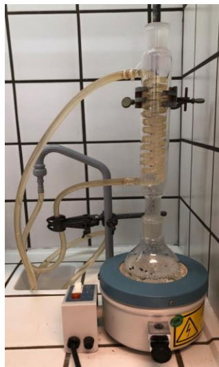
Figura 21 - Resina com água ultrapura em refluxo.
