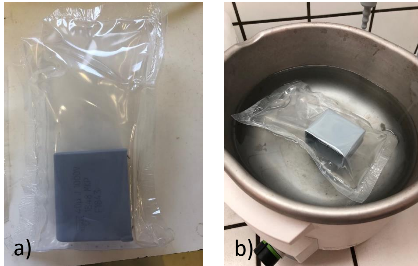
Figura 20 - Na imagem a) encontra-se a amostra selada num saco de PET com a solução de extração; na imagem b) mostra uma amostra em banho-maria.
