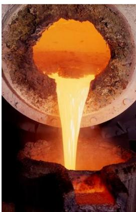
Figura 2.4 - Vazamento de metal fundido
