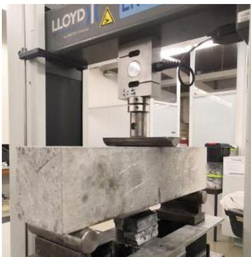
Figura 3.13 - Ensaio à flexão de um provete de betão
