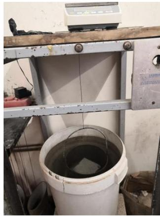
Figura 3.9 - Pesagem do provete saturado imerso em água
