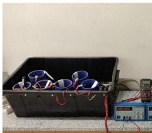
Figura 3.22 - a) Ensaio migração de cloretos com a indicação dos polos elétricos (+ e -) a conectar e a parte anódica e catódica das soluções; b) Ensaio realizado às misturas de betão leve
