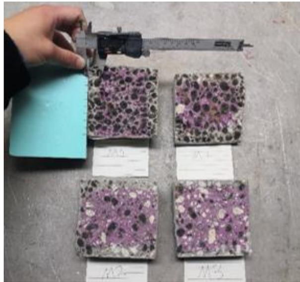
Figura 3.24 - Medição da profundidade de carbonatação nos provetes
