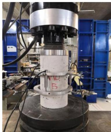
Figura 3.16 - Um provete no ensaio de módulo de elasticidade
