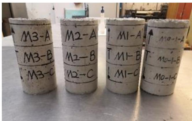
Figura 3.21 - Os provetes cilíndricos com dimensão  $\text{Ø}100 \times \text{H}50 \text{mm}$
