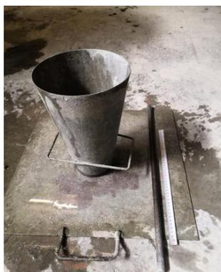
Figura 3.7 - Os equipamentos usados no ensaio de abaixamento
