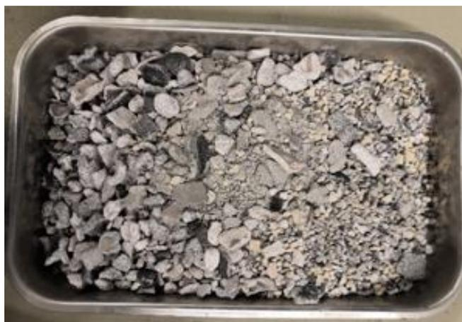
Figura 3.4 - Resíduos de moldes de cerâmica de fundição (RF)
