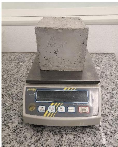
Figura 3.11 - Pesagem do provete relativamente no ensaio de capilaridade
