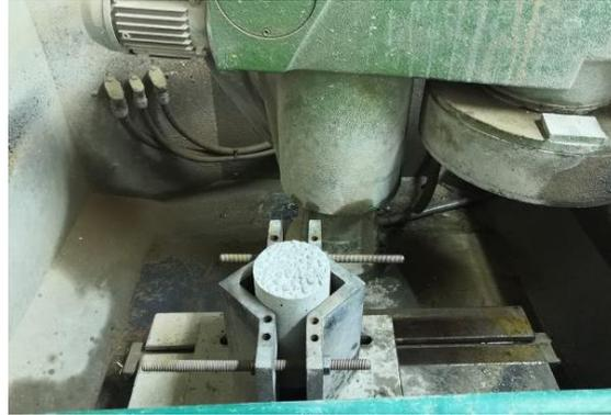
Figura 3.15 - Esmerilar os provetes cilíndricos
