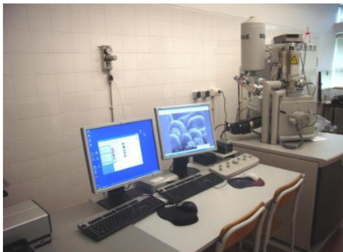
Figura 3.4 – Equipamento utilizado para analisar a morfologia dos filmes: SEM ( FEI Nova 200 (FEG/SEM); EDAX - Pegasus X4M (EDS/EBSD)).
