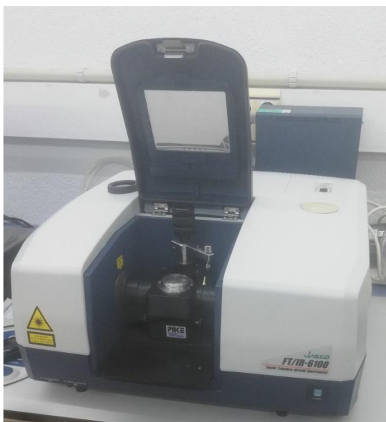
Figura 3.6 – Equipamento utilizado para o FTIR: Jasco FT/IR 6100 ATR.
