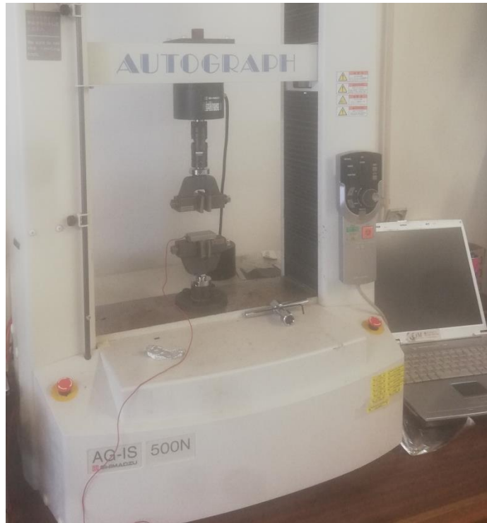
Figura 3.12 - Equipamento utilizado para fazer os testes mecânicos: Shimadzu AG-IS Autograph.
