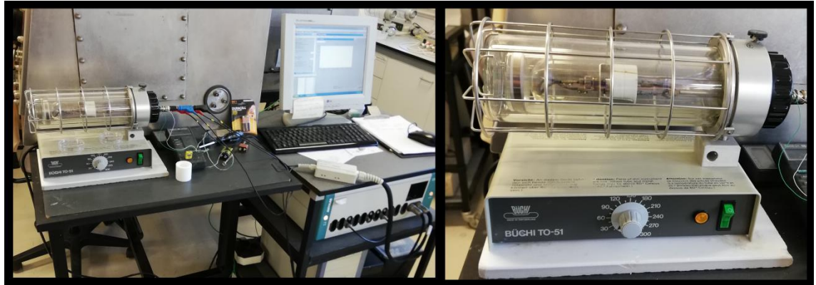
Figura 3.10 - Equipamento utilizado para medir impedâncias: Autolab PGSTAT-12/30 electrometer amplifier e forno Büchi TO-51 onde foram colocados a amostra.
