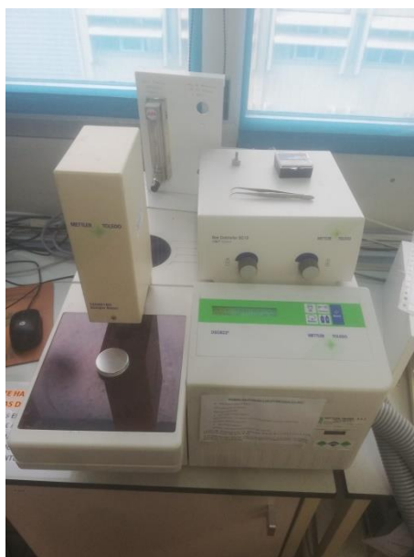
Figura 3.8 – Equipamento utilizado para o DSC: Mettler Toledo DSC 822.
