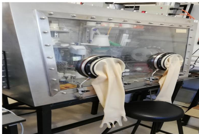
Figura 3.14– Caixa de luvas onde se montaram as baterias.
