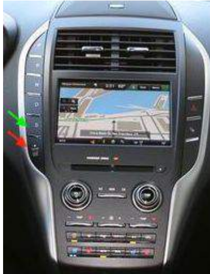
Figura 6.: Painel de Instrumentos Completo do Veículo Lincoln MKC de 2015 - Antes da Recolha do Fabricante (A seta verde indica o botão S. A seta vermelha indica o botão Start/Stop .)
