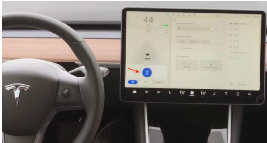
Figura 2.: Interface de Ativação das Escovas do Pára-Brisas no Painel de Instrumentos do Veículo Tesla Model 3 de 2017 (A seta vermelha representa o botão táctil que liga as escovas do pára-brisas.)
