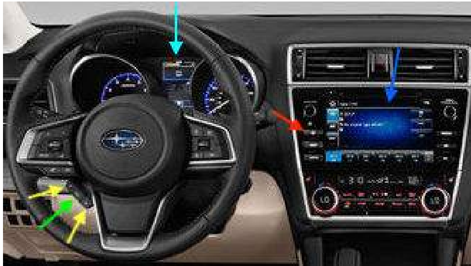
Figura 5.: Painel de Instrumentos Completo do Veículo Subaru Outback de 2018 (A seta vermelha indica o botão físico Home . A seta azul indica o ecrã táctil na consola central. As setas amarelas indicam os botões físicos com as setas para cima e/ou para baixo. A seta verde indica o botão i/set . A seta azul claro indica o pequeno ecrã LED entre o velocímetro e o tacómetro.)
