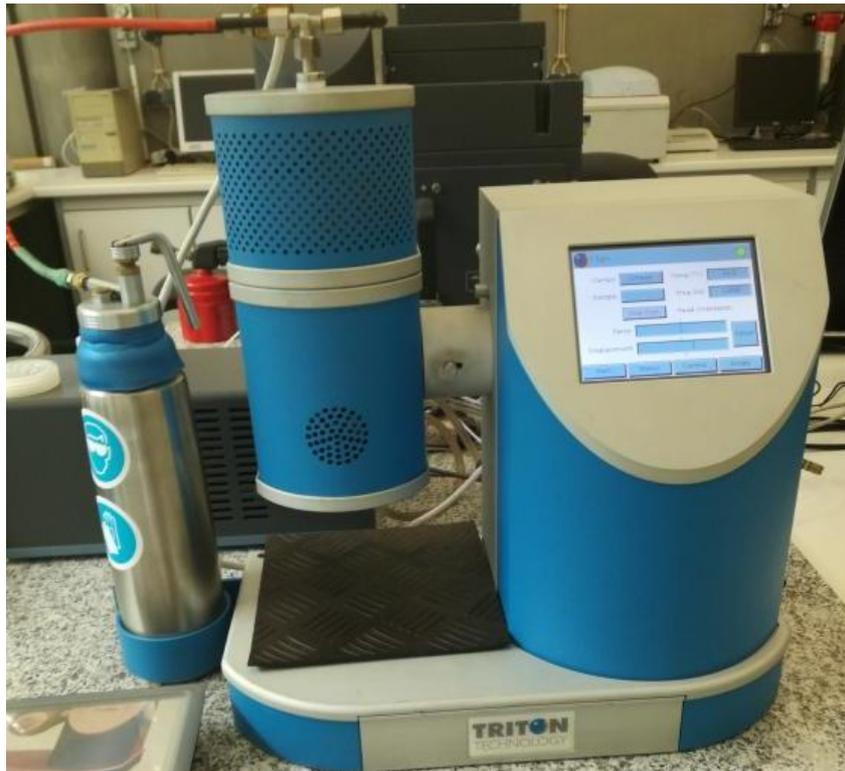
*Figura 17- Equipamento de DMA (Triton).*
