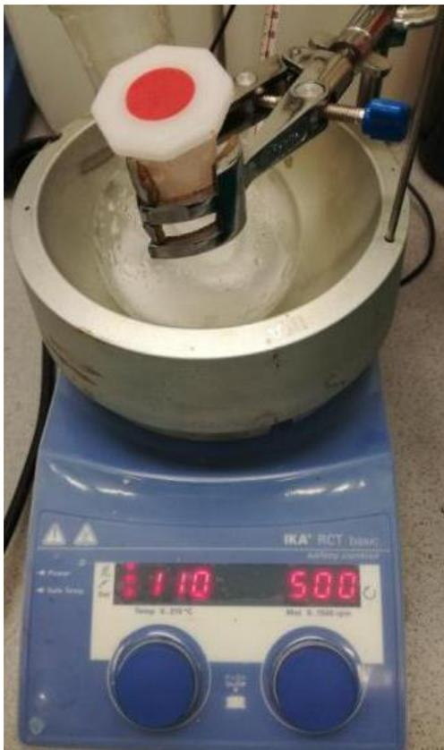
Figura 10 - Preparação da solução de PVA
