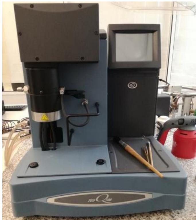
*Figura 13- Equipamento de TGA (Q500 (TA Instruments, USA)).*
