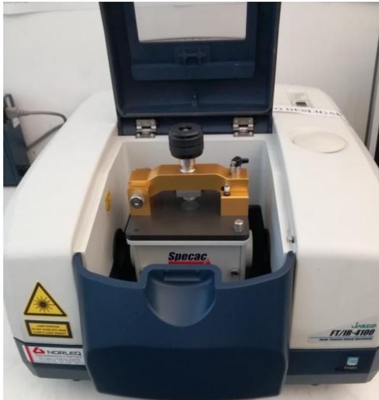
*Figura 16- Equipamento de FTIR-ATR (JASCO FT/IR 4100).*
