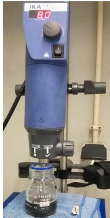
Figura 11 – Solução de PVA com grafeno a ser misturada na sonda ultra turrax
