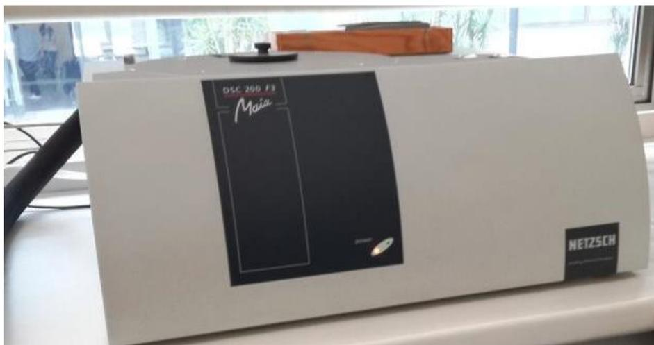
*Figura 15 - Equipamento de DSC (DSC 200 F3 Maia (Netzsch)).*
