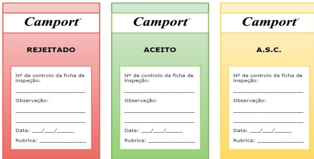
Figura 7 – Etiquetas de controlo da matéria-prima na cor vermelha (rejeitado), verde (aceito) e amarela (aceito sob condição).
