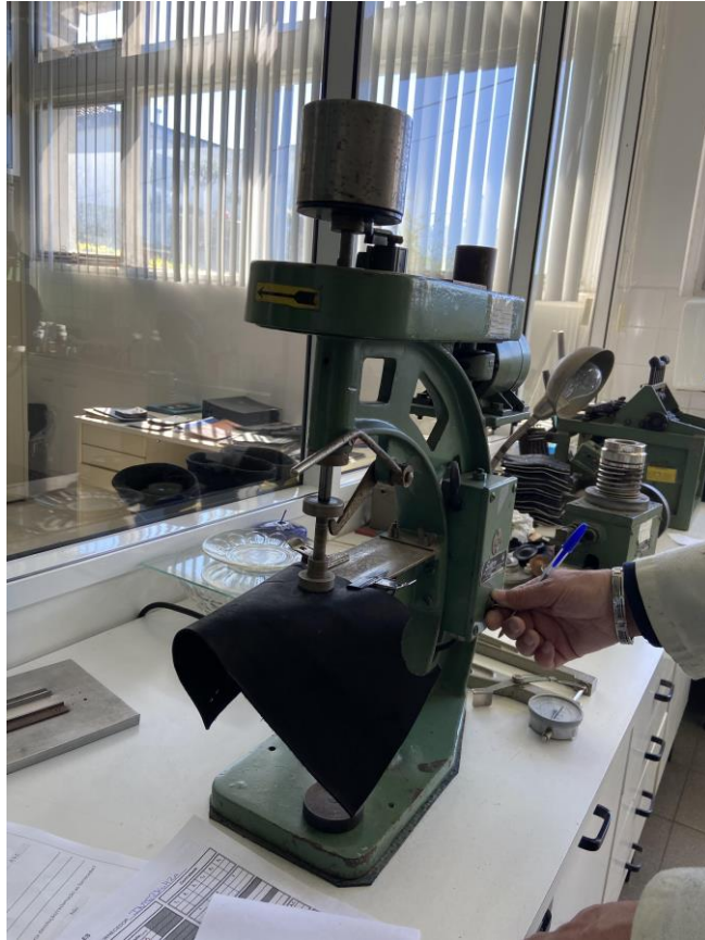
Figura 6 - Teste de resistência à tração para verificar distensão da flor da pelaria.
