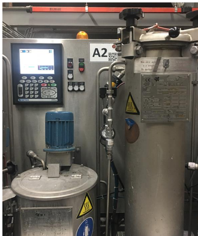
Figura 12 Autoclave de produção de pequenas quantidades.
