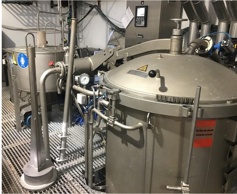
Figura 11 Autoclave de produção de grandes quantidades.
