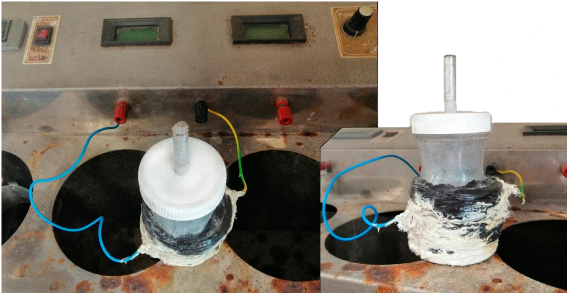
Figura 22 – Montagem do equipamento para eletrodeposição.
