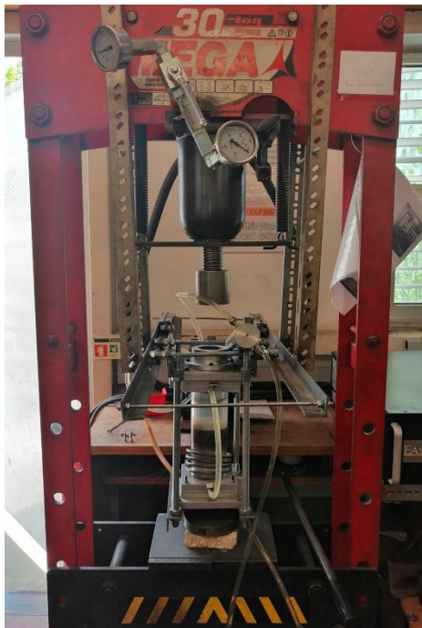
Figura 27 – Hot-pressing utilizado e representação descritiva dos componentes do Hot-pressing, respetivamente.
