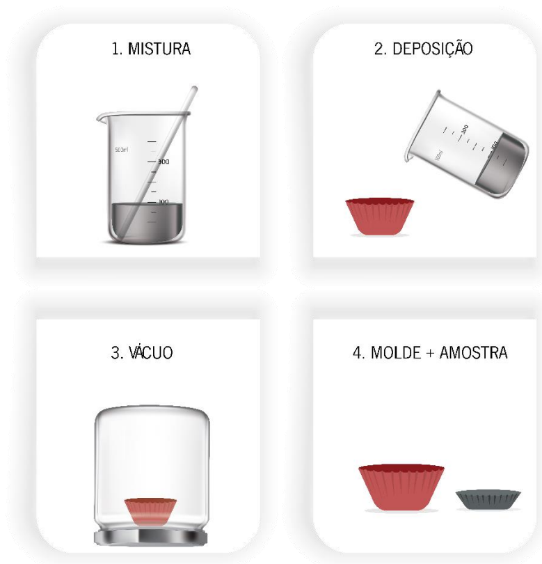
Figura 30 – Montagem dos pós em resina.
