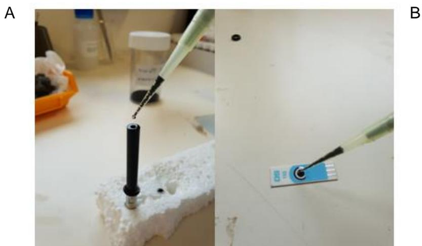
Figura 2.4- Modificação dos elétrodos de trabalho por *drop-casting* com a suspensão de CNT 1 mg/mL: (A) GCE; (B) SPCE.
