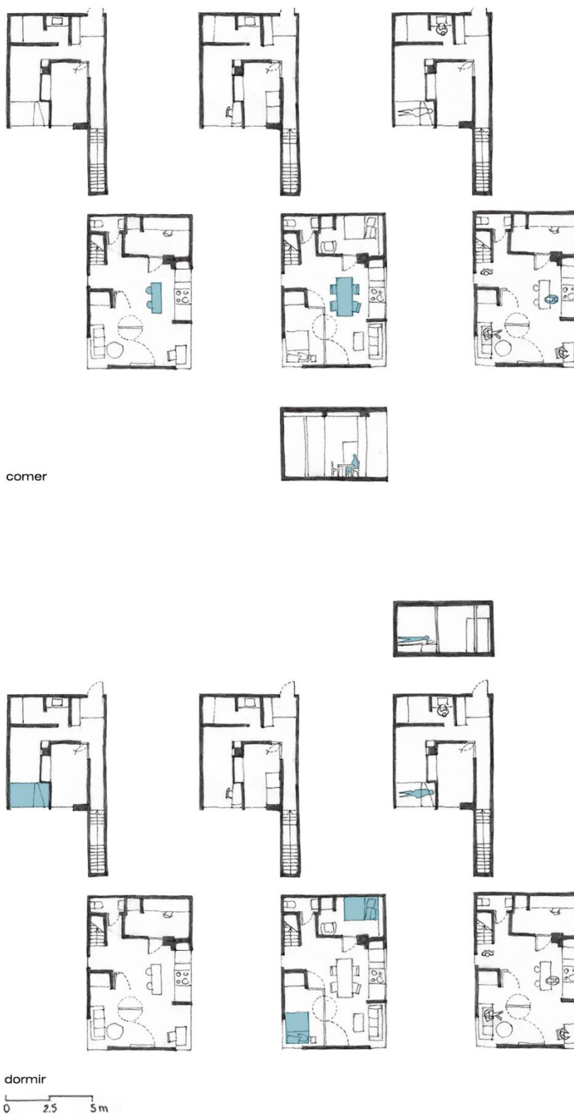
Fig.166. Esquemas interpretativos da autora. O arquiteto joga com o desenho da planta, com as cotas de piso ou com o pé direito, procurando que a luz entre nas vinte e oito habitações a partir de qualquer uma das suas fachadas. Permitindo ainda que o habitante a controle a partir da disposição interior dos elementos, segundo as mudanças sazonais, climáticas ou circunstanciais.
