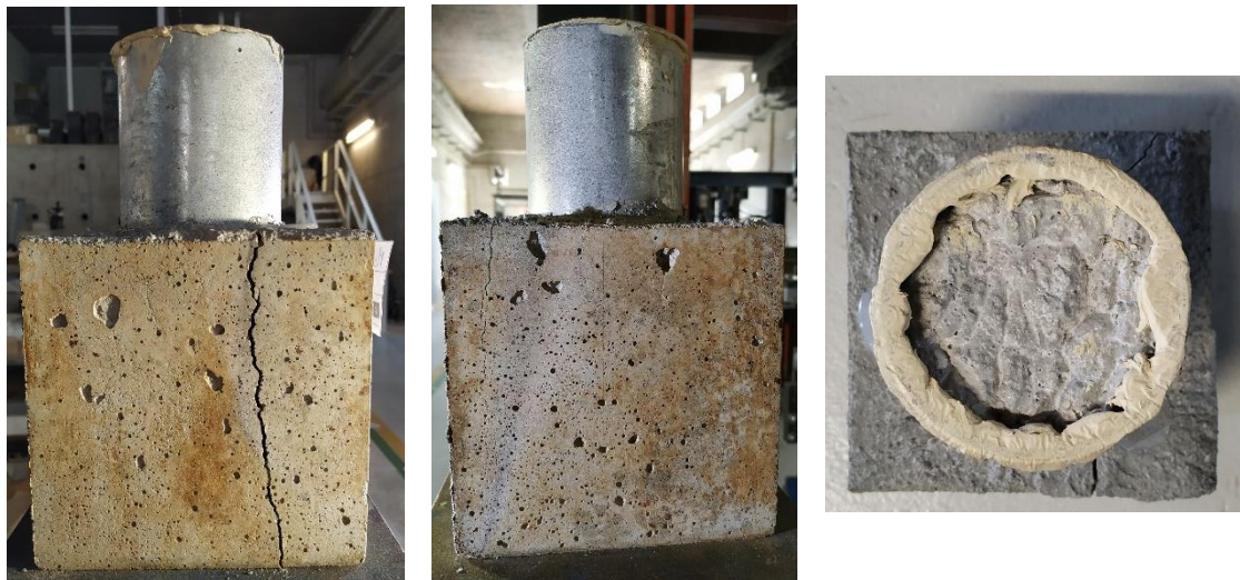
Figura 4.19: Provete M04_LB100_H40_03 após o ensaio
