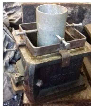
Figura 4.3: Preparação dos tubos de aço galvanizado e moldes para a colocação do betão, incluindo os elementos de aligeiramento.
