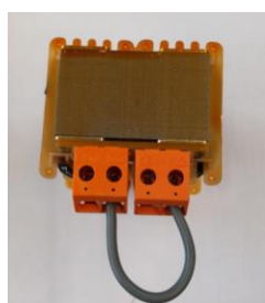
Figura 5.27 - Bobina de núcleo partilhado.
