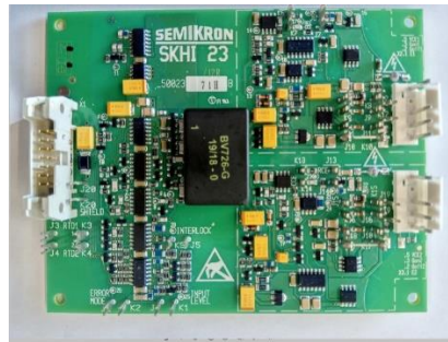
Figura 5.12 - Placa de driver modelo SKHI23, Semikron.
