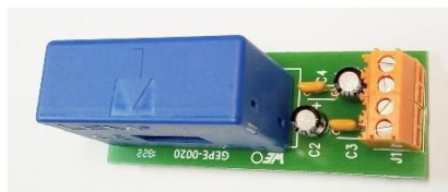
Figura 5.6 - Montagem final do sensor de corrente.
