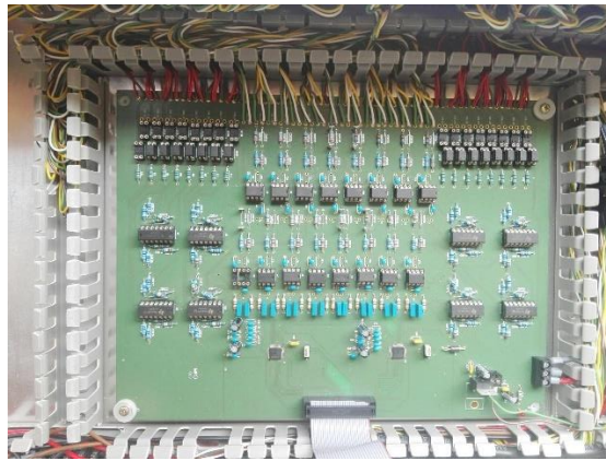
Figura 5.9 - Placa de condicionamento de sinal e deteção de erros.
