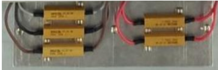
Figura 5.28 - Resistência de pré-carga.
