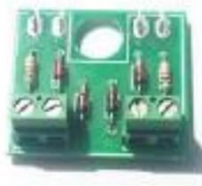
Figura 5.13 - Placa de proteção de gate dos IGBTs.
