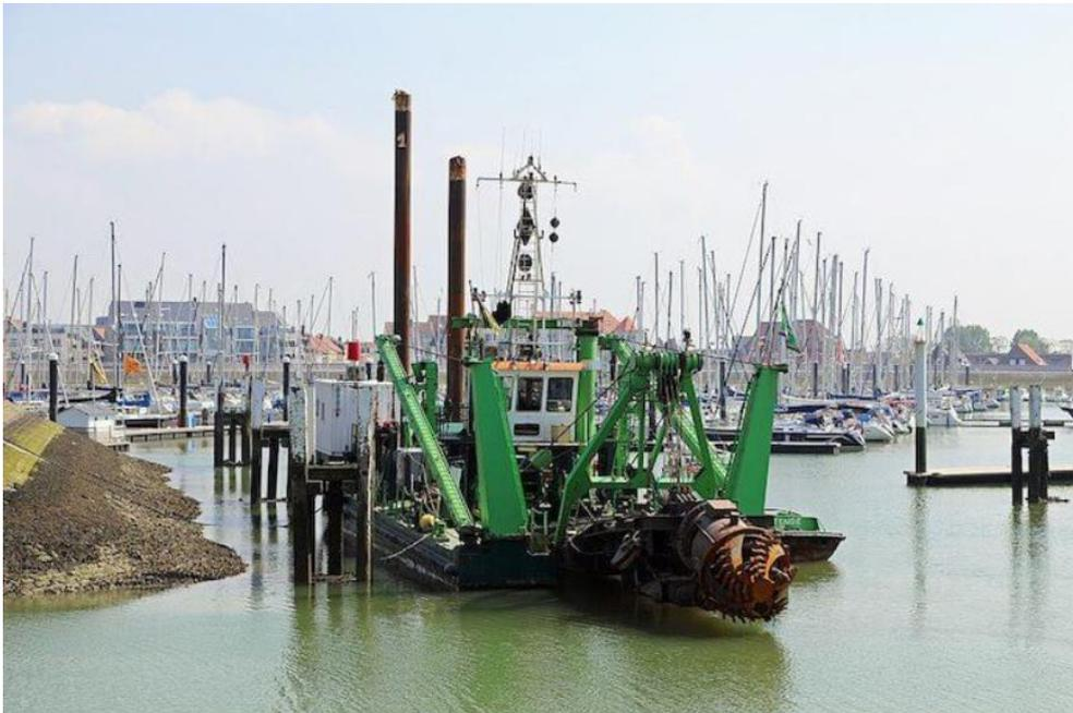
**Figura 11-** Vista frontal de uma draga de sucção com desagregador. (Retirado de Marine Insight, 2020)
