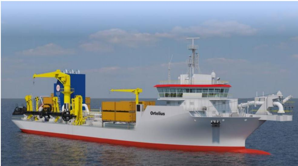
**Figura 14-** Na extremidade esquerda da figura podemos ver um dos braços de aspiração da draga auto-transportadora na sua posição inicial; na extremidade direita podemos ver o local por onde é realizada a operação de *rainbowing*. (Retirado de Jan de Nul, 2020)
