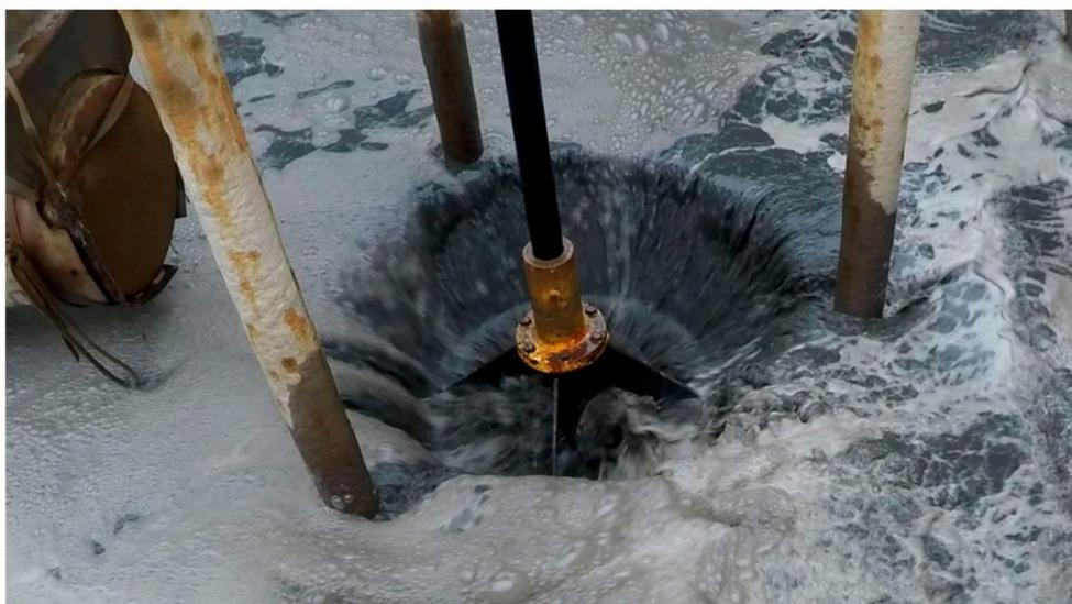
**Figura 17-** Dispositivo responsável pela remoção da mistura água + sedimento por transbordamento. (Retirado de Royal IHC, 2020b)
