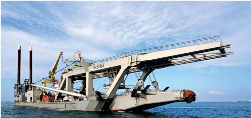
**Figura 12-** Outro exemplar de uma draga de sucção com desagregador. (Retirado de Boskalis, 2020a)
