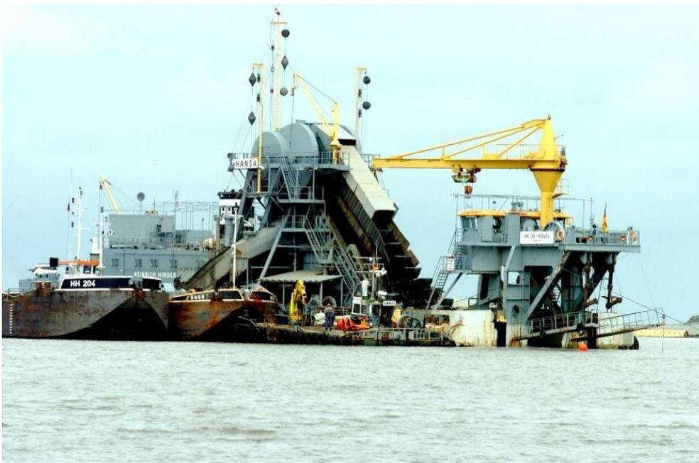
**Figura 5-** Draga de balde em operação. (Retirado de IADC, 2020a)
