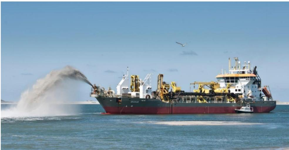
**Figura 15-** Dragagem auto-transportadora a devolver o material dragado através de *rainbowing*. (Retirado de Boskalis, 2020b)
