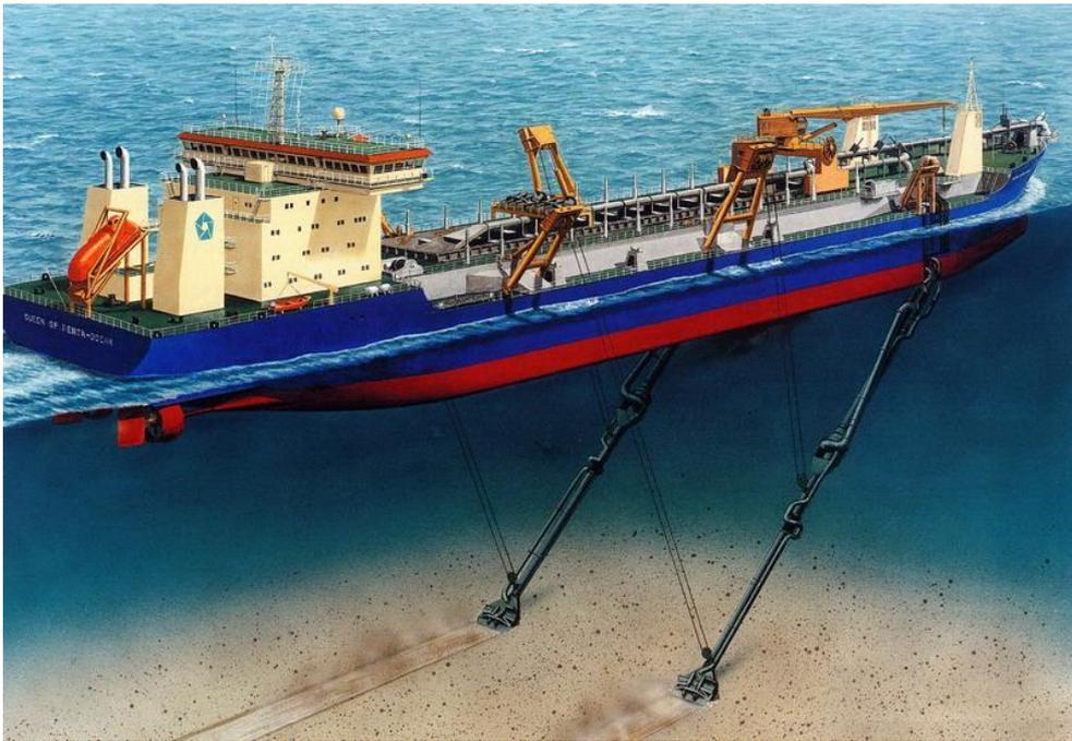
**Figura 13-** Draga auto-transportadora em funcionamento, com os braços de aspiração no leito do mar. (Retirado de Confluence, 2020)
