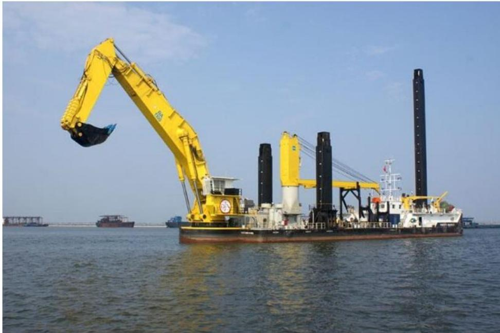
**Figura 9-** *Draga de retroescavadora.* (Retirado de Offshore Industry and Technology Journal, 2017)
