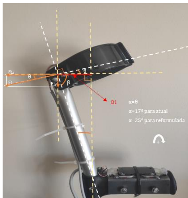
Figura 93 - Representação esquemática das forças registradas ao nível do aro
