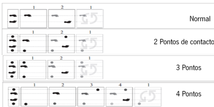
Figura 13 - Diferentes padrões de marcha em função do número de contactos (Adaptado de [29])
