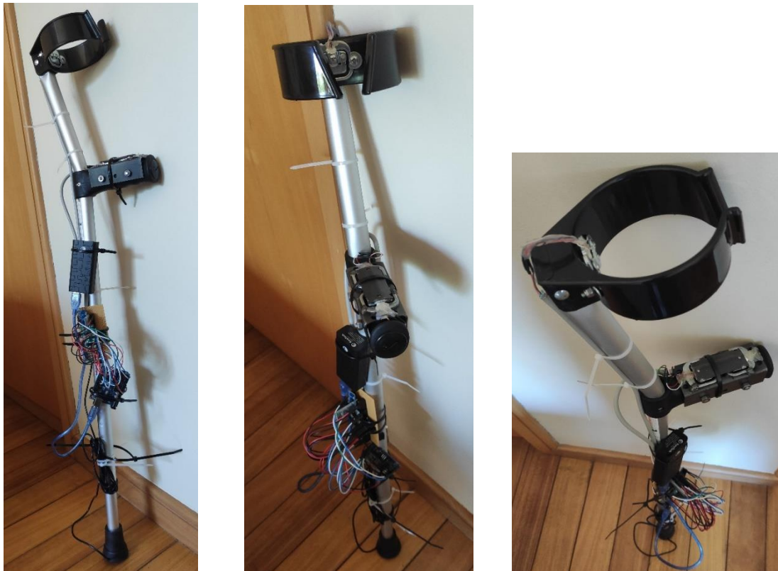
Figura 71 - Diferentes vistas da canadiana totalmente instrumentada
