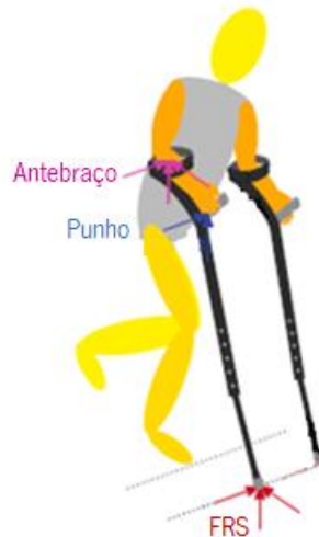
Figura 17 - Forças de reação do solo aplicadas na ponta do auxiliar e nos membros superiores (Adaptado de [29])
