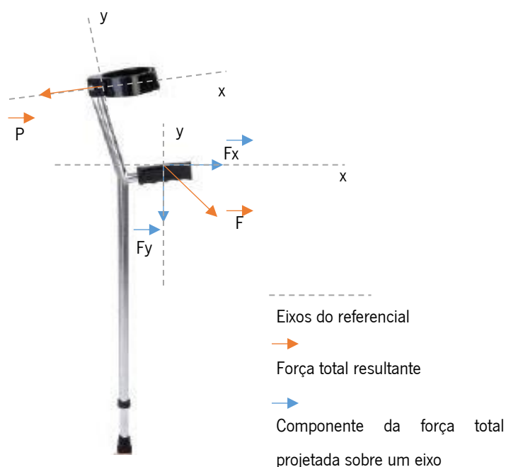
Figura 16 - Representação da decomposição em componentes das forças aplicadas pelo utilizador na estrutura geral da canadiana
