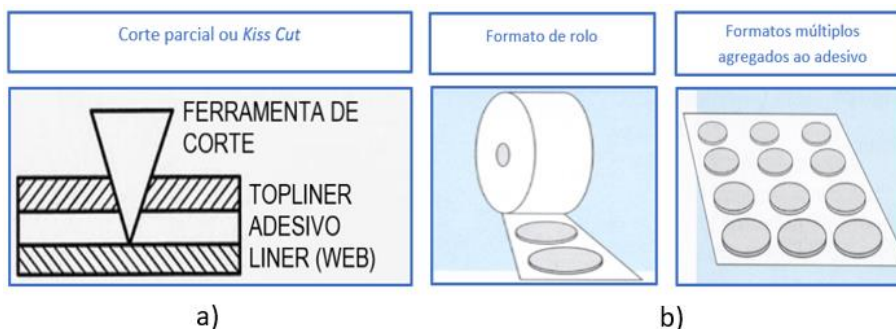
Figura 25- a) Esquemática do processo corte parcial e b) Produto final obtido através de corte parcial
