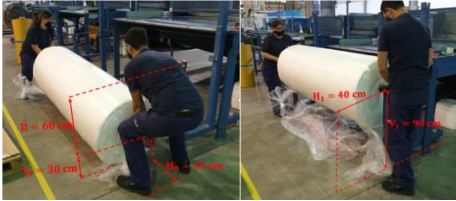
Figura 48- Diferenças nas condições de execução da tarefa entre o início e o fim da elevação da bobine
