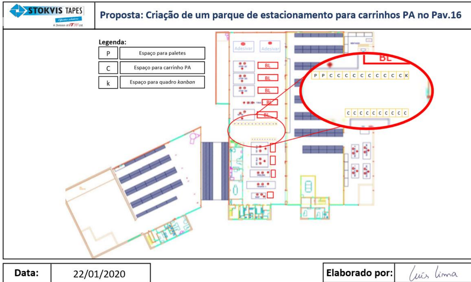
Figura 97- Proposta de criação de um parque de estacionamento para carrinho PA no pav.16
