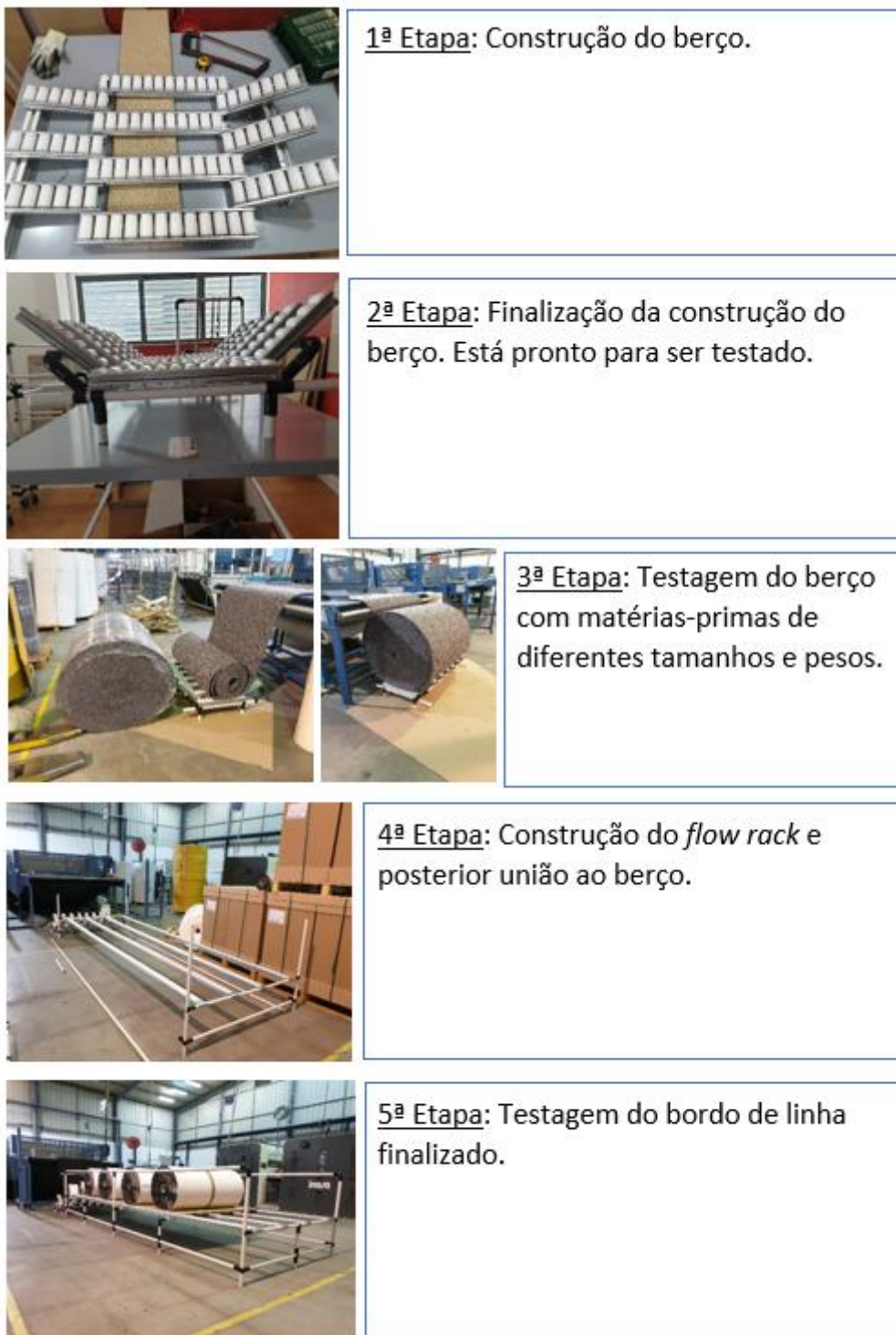
Figura 99- Etapas de construção do bordo de linha para as prensas
