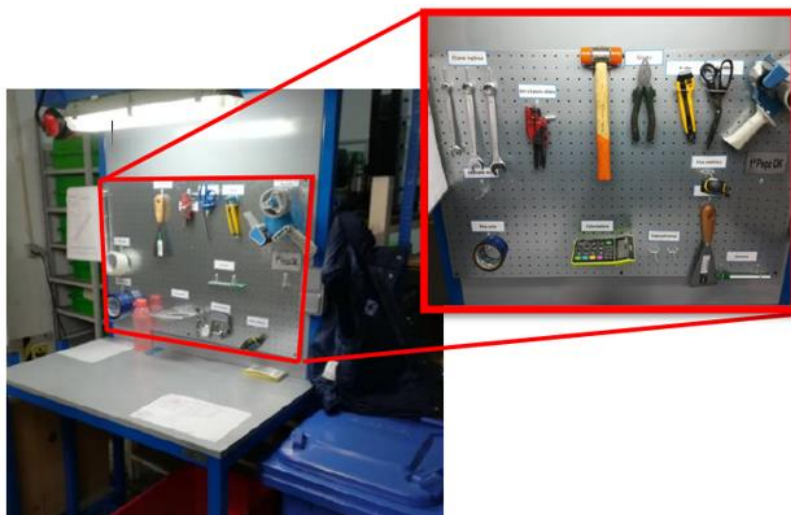
Figura 64- Exemplo de implementação de 5S nas mesas de trabalho das máquinas kiss cut
