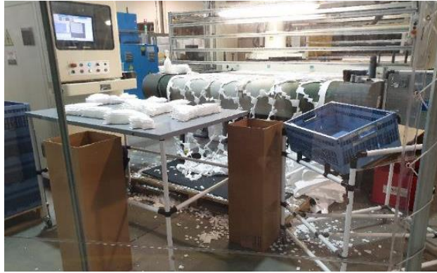
Figura 74- Exemplo de um posto de trabalho com acumulação de sucata
