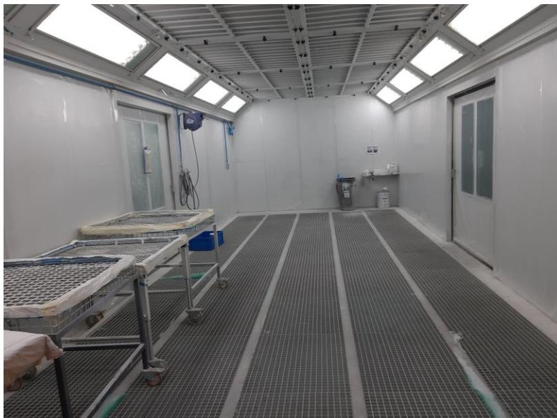
Figura 48 – Cabine de pintura limpa, organizada e com o novo isolamento
