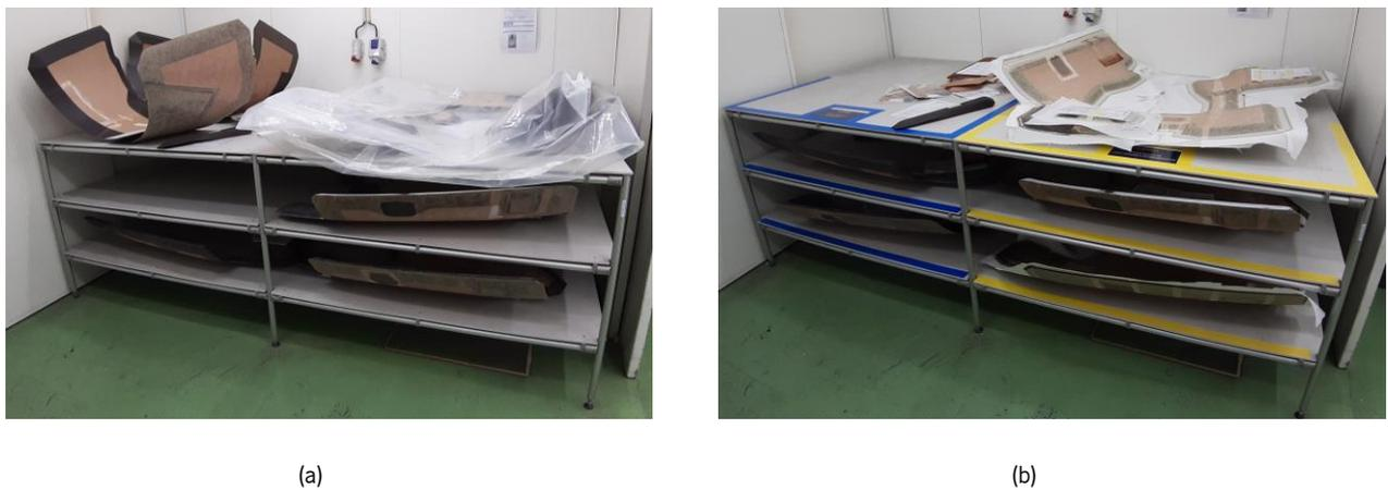
Figura 30 – (a) Processo de preparação de núcleos pré 5S's e (b) Processo de preparação de núcleos pós 5S's
