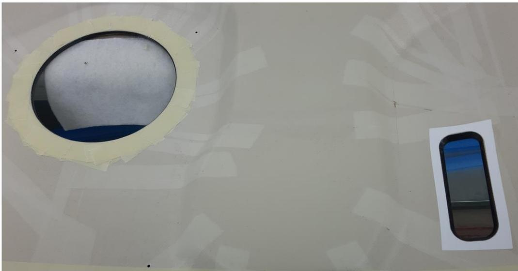
Figura 40 – Isolamento em fita cola (esquerda) e em vinil (direita)
