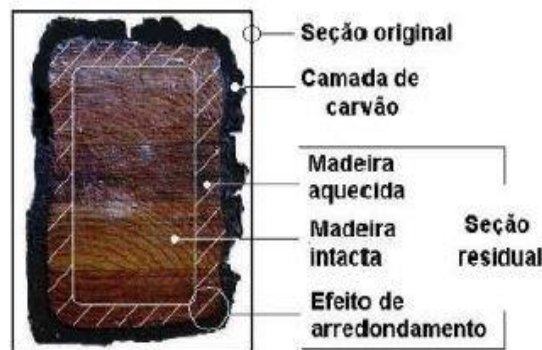
Figura 5 - Viga Carbonizada (Anastácio, 2010).
