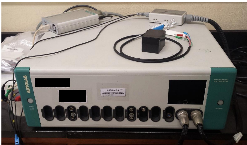
Figura 29 – Potencióstato/galvanostato utilizado para a aquisição dos registos voltamétricos.
