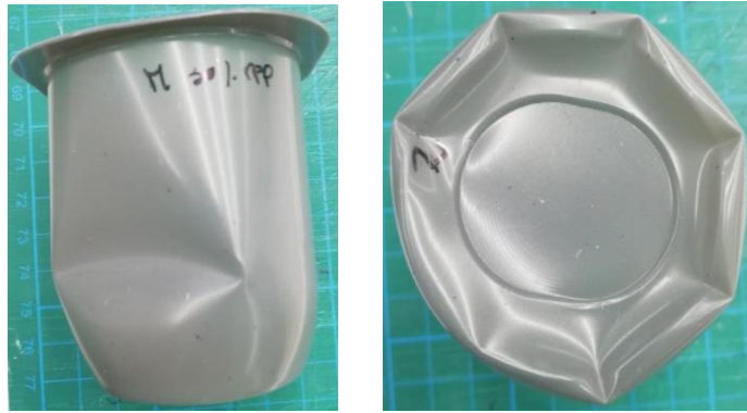
FIGURA 57: COPOS APÓS ENSAIO DE RCV
