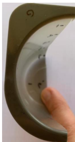
FIGURA 11: PONTO DE REFERÊNCIA NA MEDIÇÃO DE ESPESSURA
