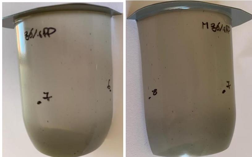
FIGURA 13: PONTOS DE MEDIÇÃO AO LONGO DA LINHA DO PUNÇÃO
