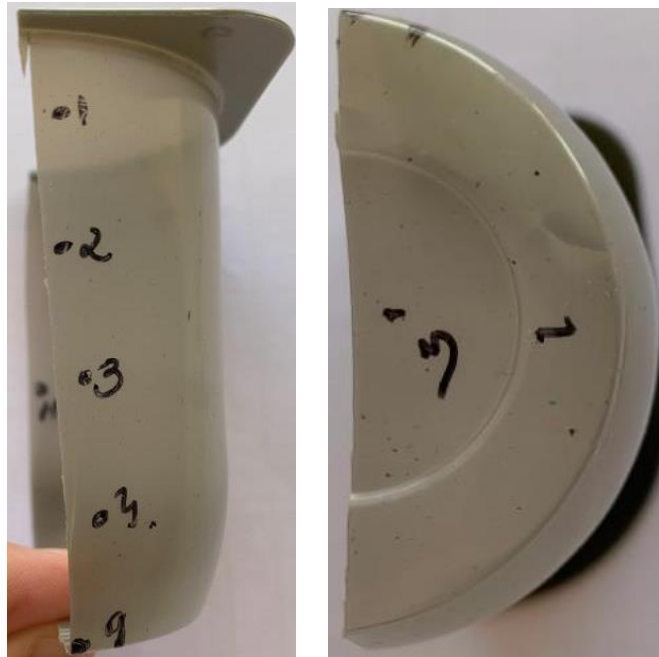
FIGURA 12: PONTOS DE MEDIÇÃO AO LONGO DO COPO
