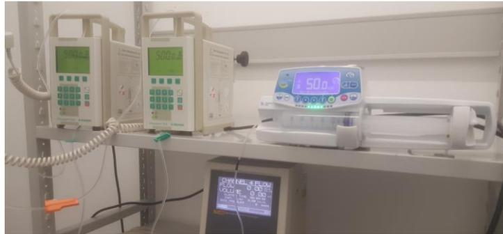
Figura 5.9 – Manutenção preventiva de bombas e “seringas” infusoras – a) Esquema dos procedimentos de manutenção preventiva; b) Realização da manutenção preventiva a duas bombas infusoras *BBraun Infusomat FMS* e uma “seringa” *Fresenius Kabi Injectomat MC AGILIA P*.
