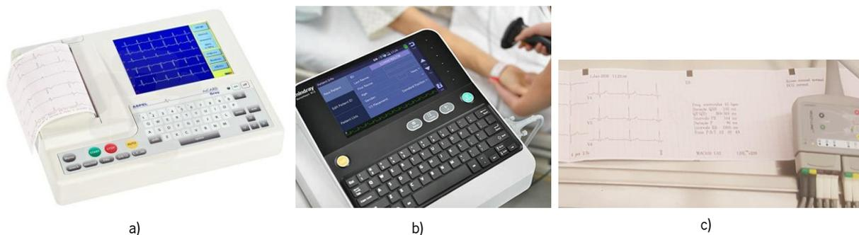
Figura 4.8 – Tipos de eletrocardiografos presentes no HTQ – a) eletrocardiografo Aspel Mr. Grey (Utlmédica, 2019) ; b) eletrocardiografo Mindray R12 (Medical Expo, 2020); c) traçado do ECG de um dos testes de manutenção preventiva ao GE Mac600 do HTQ.
