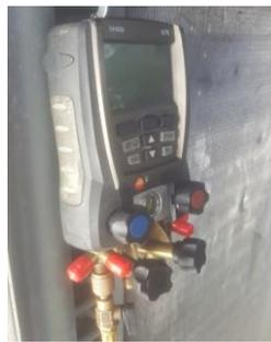
Figura 5.6 – Equipamento de teste para sistemas de refrigeração - Testo 570.
