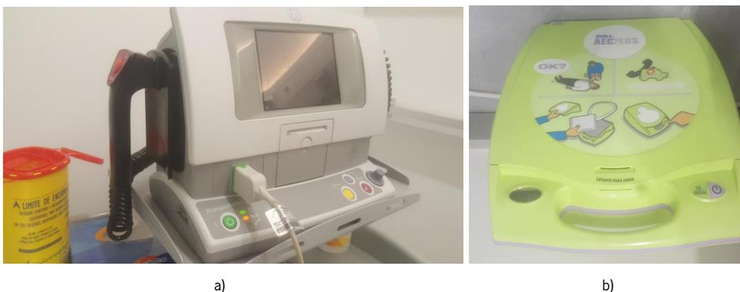
Figura 4.1 – Desfibrilhadores existentes no HTQ – a) desfibrilhador manual GE Responder 2000; b) desfibrilhador automático externo ZOLL AED Plus.
