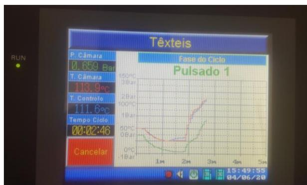
Figura 5.15 – Display do autoclave no decorrer do ciclo de teste de esterilização.
