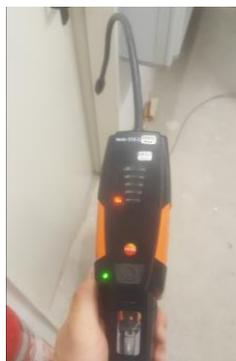
Figura 5.5 – Equipamento de teste de fugas de fluidos frigoríficos - Testo 316-3.
