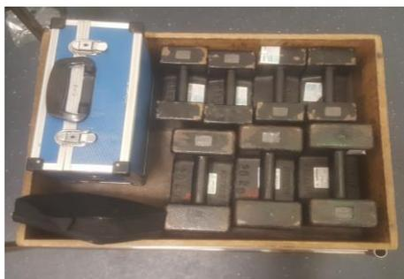
Figura 5.12 – Massas padrão utilizadas pelo SUCH na manutenção de balanças.
