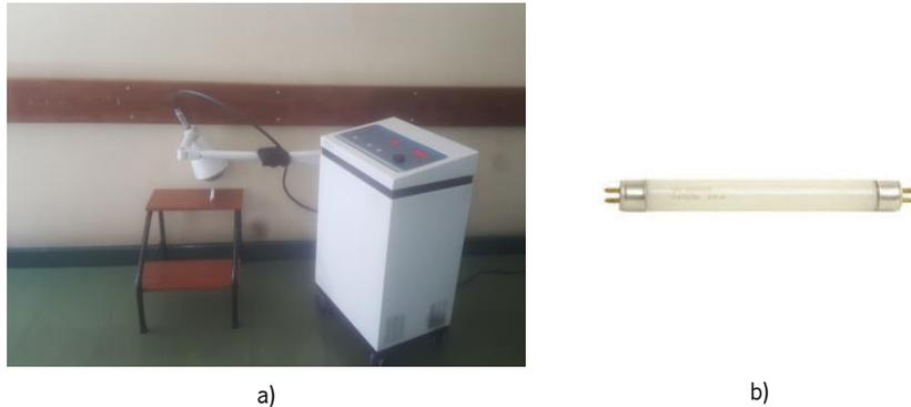
Figura 5.10 – a) Aparelho de micro-ondas Elios da UHC em testes funcionais; b) Lâmpada fluorescente 4W T5 usada na manutenção preventiva
