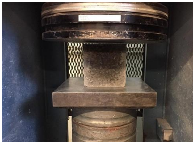
Figura 18 - Ensaio à compressão de um provete de betão com dimensões 100x100x100mm 3
