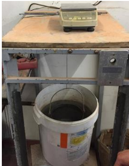
Figura 22 - Pesagem do provete saturado dentro de água
