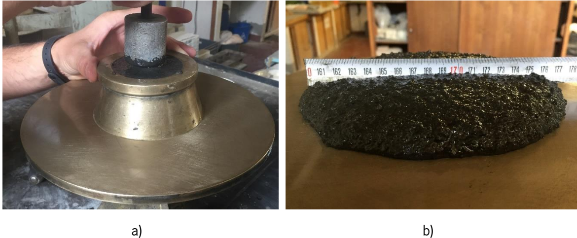
Figura 33 - Determinação da consistência das argamassas, a) mesa de compactação, b) espalhamento da argamassa
