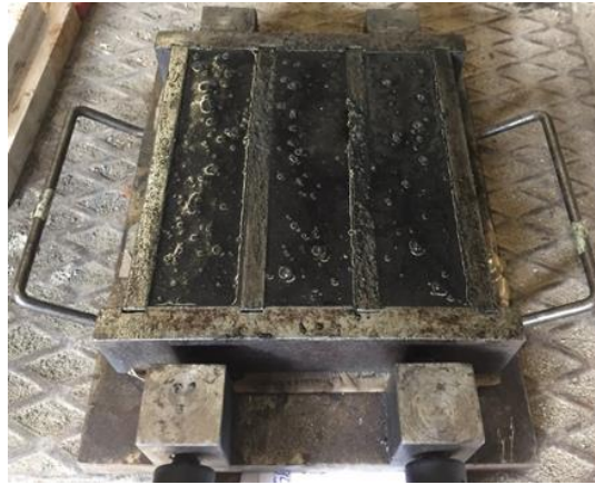
Figura 15 - Moldagem da argamassa
