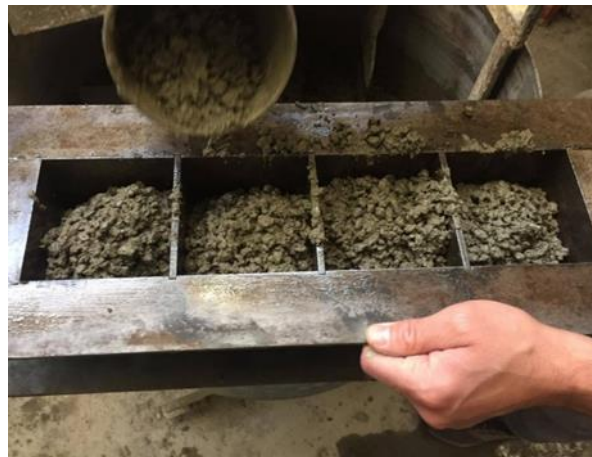
Figura 17 - Moldagem dos BAA em moldes com dimensões 100 \times 100 \times 100 \text{mm}^3
