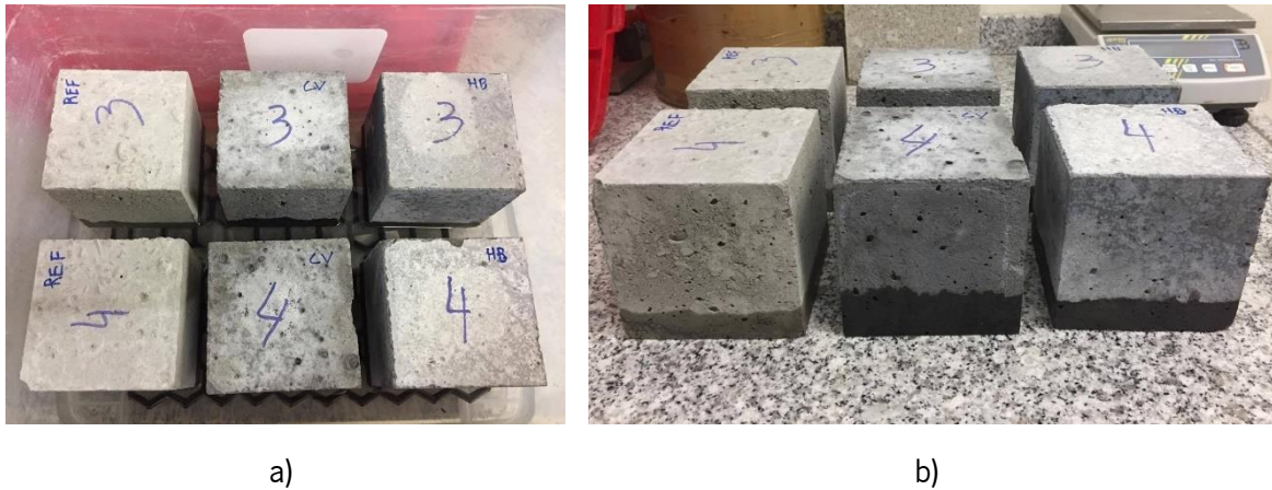
Figura 23 - Ensaio de absorção por capilaridade dos provetes, a) dentro do recipiente, b) fora do recipiente antes do efetuação da pesagem
