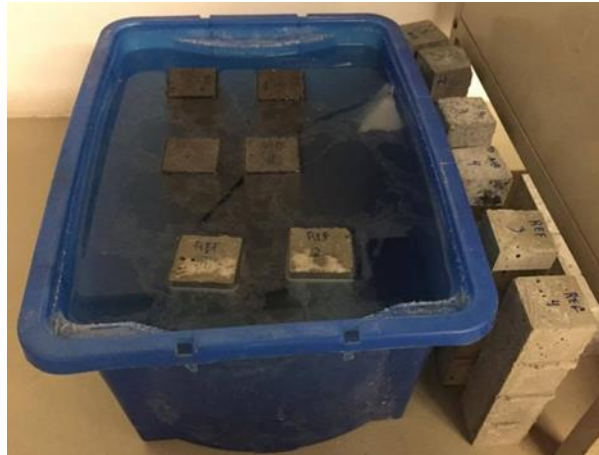
Figura 20 - Metade dos provetes fabricados submersos em água para o ensaio de estabilidade à água
