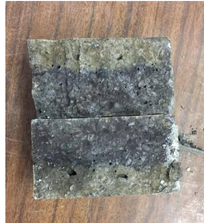
Figura 28 - Ensaio de migração de cloretos, a) provetes envoltos da manga de borracha no recipiente catódico, b) metades de um provete após o ensaio
