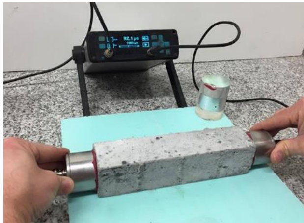
Figura 27 - Ensaio de ultrassons a um provete de betão
