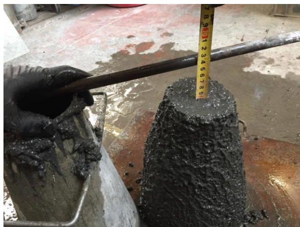
Figura 57 - Abaixamento do BAA 90%CV10%CEM
