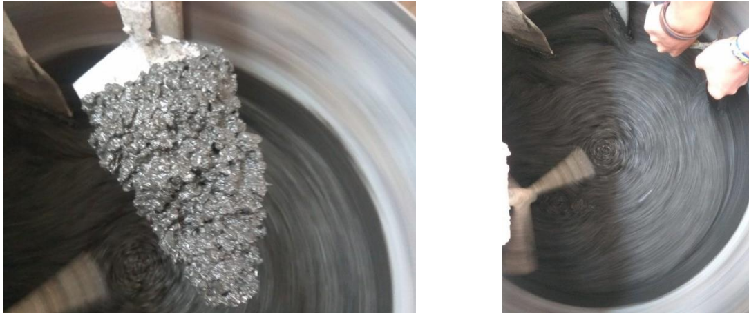
Figura 16 - Processo de mistura do BAA na betoneira
