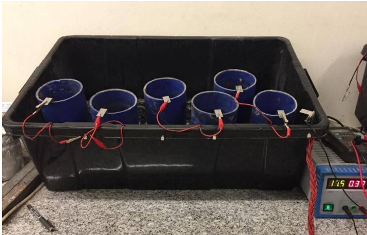
Figura 28 - Ensaio de migração de cloretos, a) provetes envoltos da manga de borracha no recipiente catódico, b) metades de um provete após o ensaio
