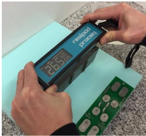
Figura 26 - Medição da resistividade de um provete de betão
