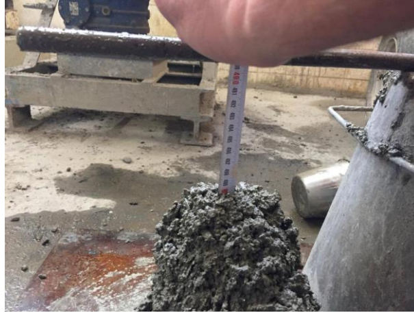
Figura 58 - Abaixamento do betão de referência
