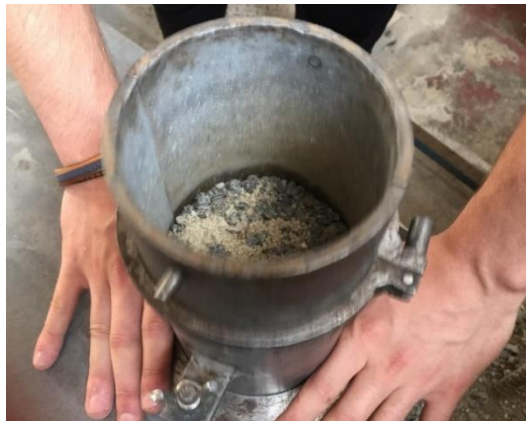
Figura 38 - Meio molde preenchido com agregado na mesa vibratória
