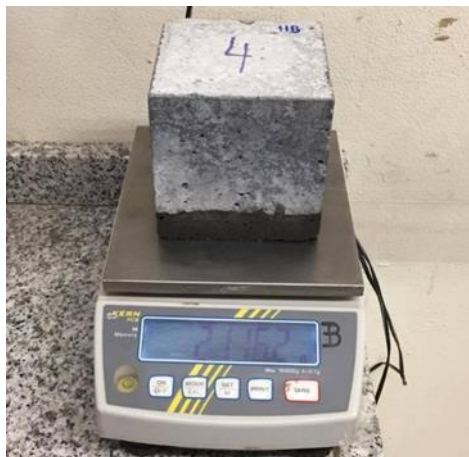
Figura 24 - Pesagem de um provete de betão no ensaio de capilaridade
