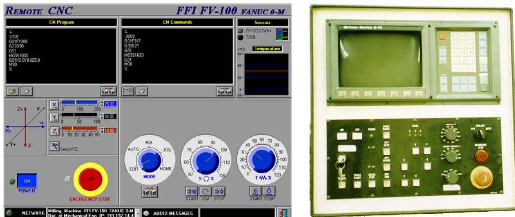
Fig. 6.1 - Painel Virtual remoto *versus* Painel Real da fresadora FFI FV-100 FANUC 0-M.
