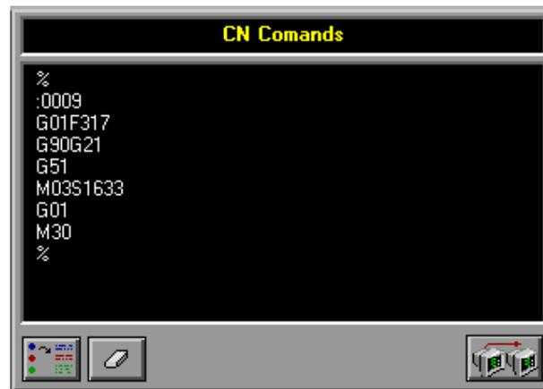
Fig. 5.15 - Geração de um programa de CN a partir dos botões do painel virtual remoto.
