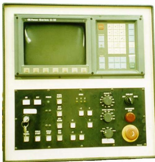
Fig. 5.4 - Painel da unidade de controlo da fresadora FFI FV-100.
