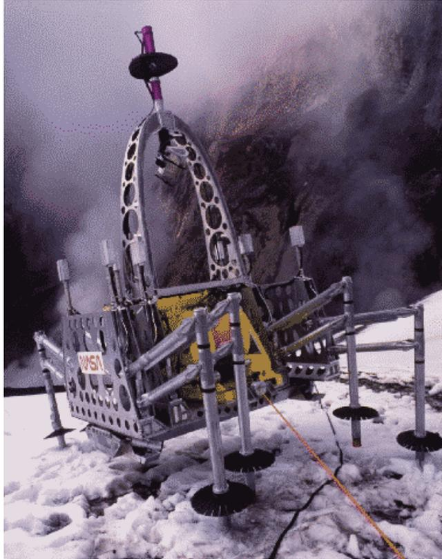
Fig. 2.3 - Robot Dante II - Recolha de amostras em vulcões [de WWW-IMG 97].
