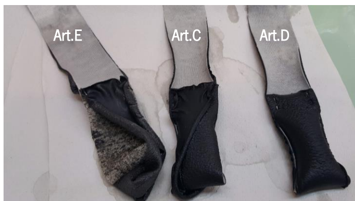
Figura 56 - Provetes após teste de imersão em acetona.
