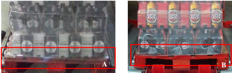
Figura 4.2. Imagens ilustrativas de um envolvimento insuficiente. A - Filme envolve o estrado de madeira; B - Filme não envolve o estrado de madeira.
