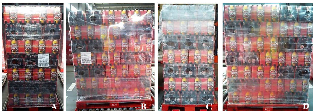
Figura 5.5. Imagens ilustrativas das quatro direções das paletes para identificação dos tabuleiros com quebra. A – D800mm com etiqueta. B – D1200mm com etiqueta. C – D800mm sem etiqueta. D – D1200mm sem etiqueta.
