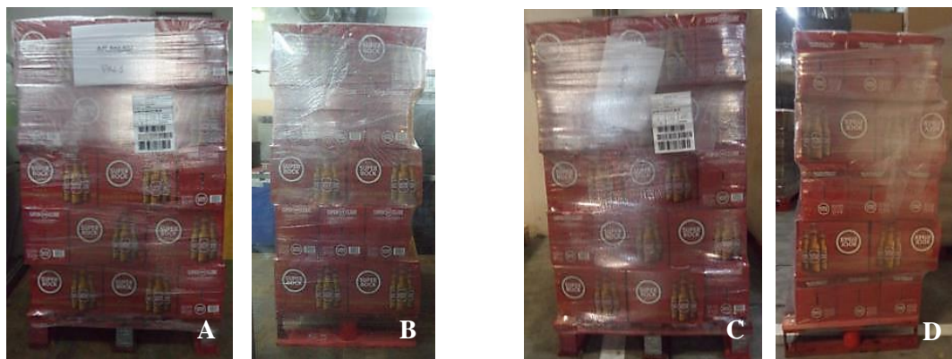
Figura 6.23. Imagens ilustrativas da matriz original 1 antes e depois do teste de estabilidade. A – D800mm antes do teste. B – D600mm antes do teste. C – D800mm depois do teste. D – D600mm depois do teste.
