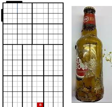
Figura 6.16. Posição da garrafa partida no tabuleiro e palete e reconstrução da respetiva garrafa na análise fratográfica. B – Fiada 1.
