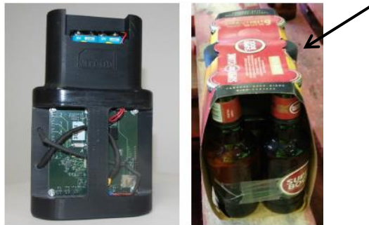
Figura 5.15. Imagem representativa do “ Dummy ” e sua colocação numa embalagem shrink Super Bock.
