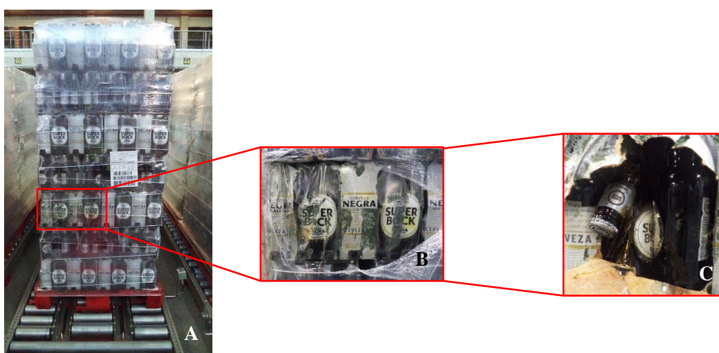
Figura 1.3. Evidências de garrafa partida. A - Palete com tabuleiro com sinais de garrafa partida. B - Pormenor do tabuleiro com bolores. C - Garrafa partida no interior do tabuleiro.
