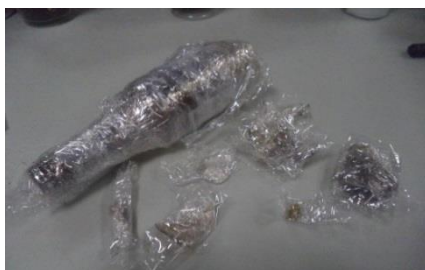
Figura 5.10. Acondicionamento dos fragmentos de vidro para envio para o American Glass Research .
