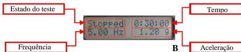
Figura 5.19. Imagens ilustrativas do controlo remoto. A - Funções disponíveis no controlo remoto. B - Definições presentes no ecrã LCD do controlo
