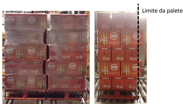
Figura 5.21. Imagens ilustrativas da paletização de ½ paleta de produto caixa. A - Paletização das duas ½ paletes é realizada em simultâneo. B - Algumas caixas ultrapassam o limite da paleta devido ao desenho da matriz e desempenho da paletização.
