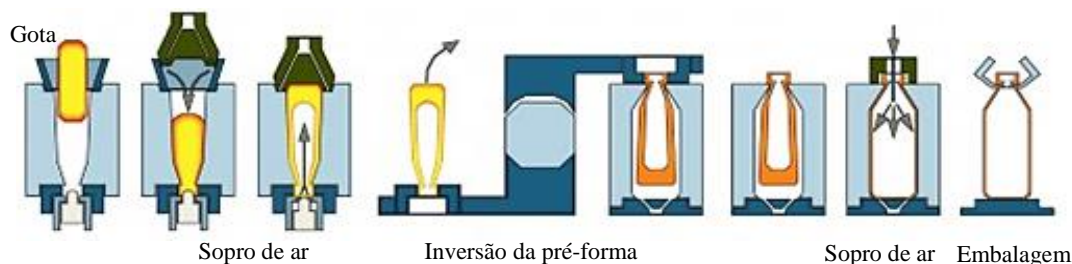
Figura 3.5. Imagem esquemática do processo de moldação soprado-soprado [22] (adaptado).
