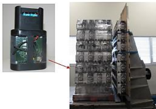
Figura 5.17. Colocação do “ Dummy ” numa paleta com embalagem secundária shrink .
