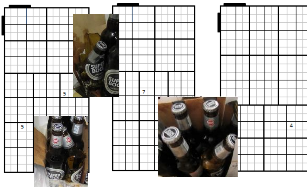
Figura 6.20. Posição e imagens das garrafas partidas na matriz correspondente.
