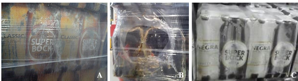
Figura 6.1. Demonstração de tabuleiros com sinais de garrafa partida. A – Bolores numa embalagem 6 pack shrink de Super Bock; B – Bolores numa embalagem 6 pack shrink de Cristal; C – Ressoado numa embalagem 6 pack shrink de Super Bock.
