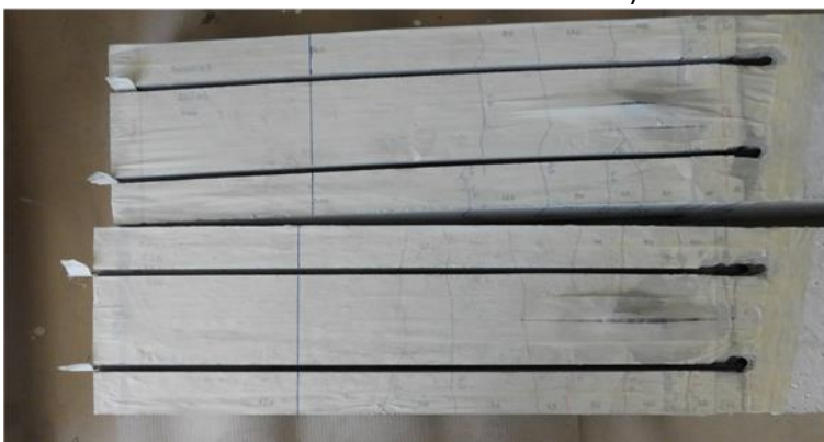
Figura 2 – a) Esquema de ensaio, b) Rasgos e furos para aplicação da nova geração de reforços em CFRP
