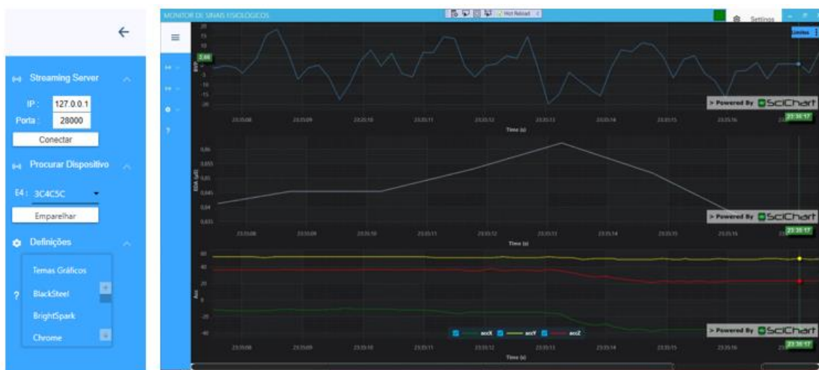
Figura 61: Esquerda: Menu de conexão ao servidor e emparelhamento à E4 do lado; Direita: Visualização Gráfica dos dados enviados pela E4.
