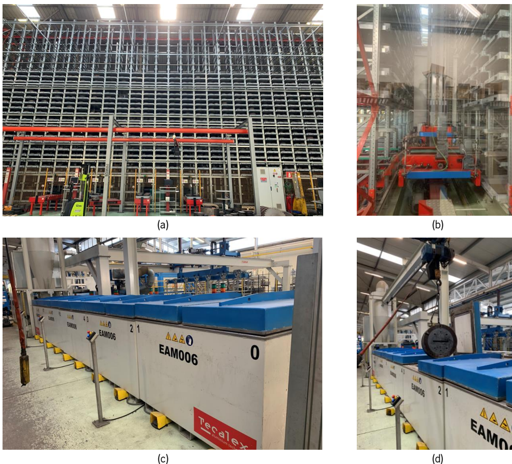
Figura 21 - (a) Armazém de matrizes (b) Robô do armazém (c) Estufas (d) Matriz a sair da estufa
