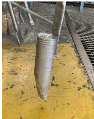
Figura 26 - Grafite na ferramenta para ser colocada manualmente
