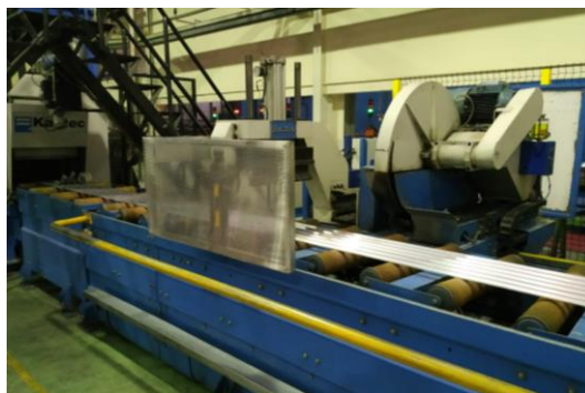
Figura 37 - Solução para proteção da serra do puller
