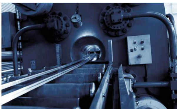
Figura 19 - Início do processo de extrusão (perfil sai da prensa com a secção transversal da matriz)
