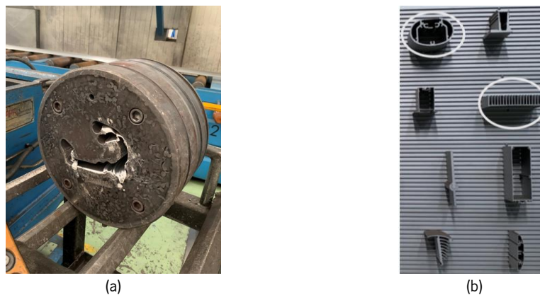
Figura 20 - (a) Matriz plana (com uma saída) (b) Perfil tubular (em cima) e plano (em baixo)
