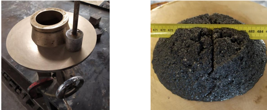
Fig. 5.16 – Determinação da consistência das argamassas, a) mesa de compactação, b) espalhamento da argamassa
