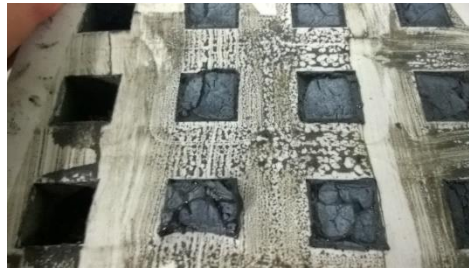
Fig. 5.1 - Pastas sem endurecimento após 6 dias expostas a temperatura ambiente
