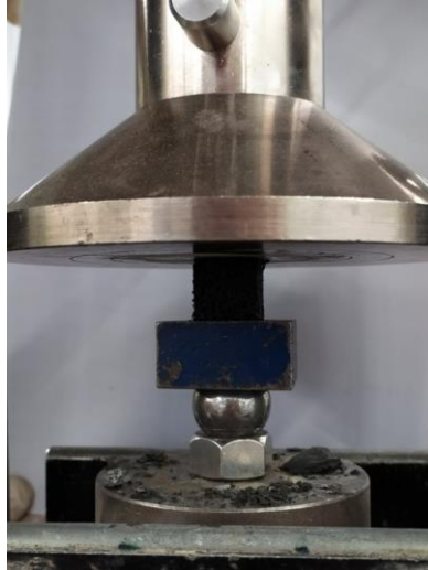
Fig. 3.11 Exemplo do ensaio à compressão das pastas.
