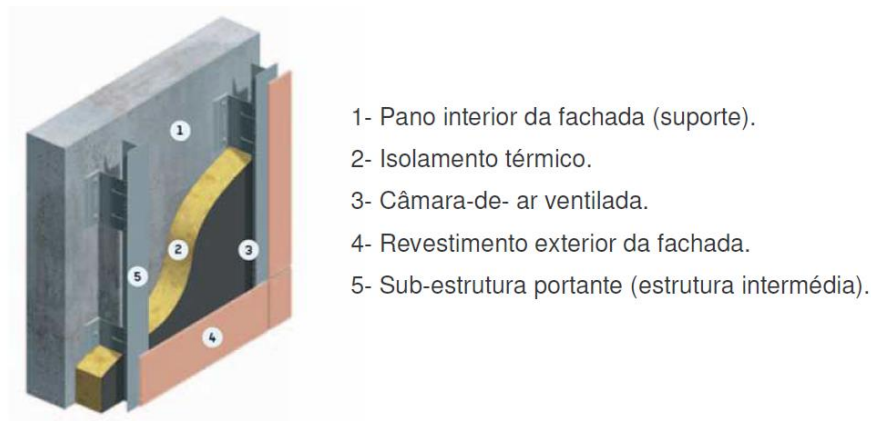
Figura 15 - Composição tipo de uma fachada ventilada (Mendes, 2009)
