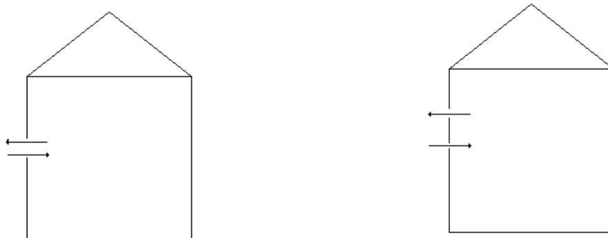
Figura 2.7: Ventilação unilateral com uma abertura (à esquerda) e com duas aberturas (à direita) (Pinto, 2014)
