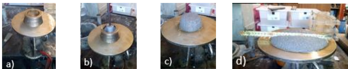
Figura 3.7 - Procedimento do ensaio de espalhamento.
