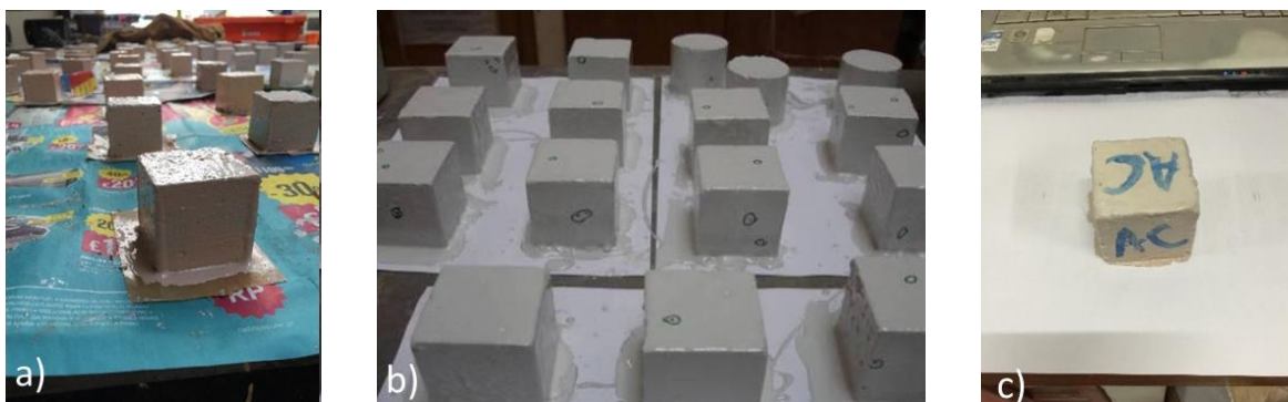
Figura 3.6 - Processo de pintura dos cubos com tinta epóxi.
