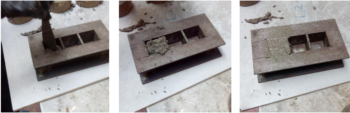
Figura 3.5 - Colocação das duas camadas de argamassa no molde.
