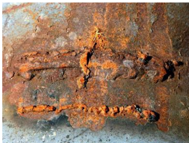
Figura 2.11 - Exemplo de corrosão uniforme [24].
