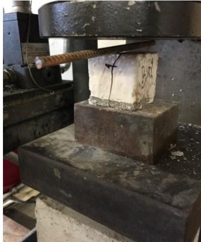
Figura 3.9 - Rompimento dos provetes.
