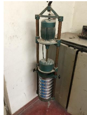
Figura 3.2 - Agitação com auxílio mecânico.
