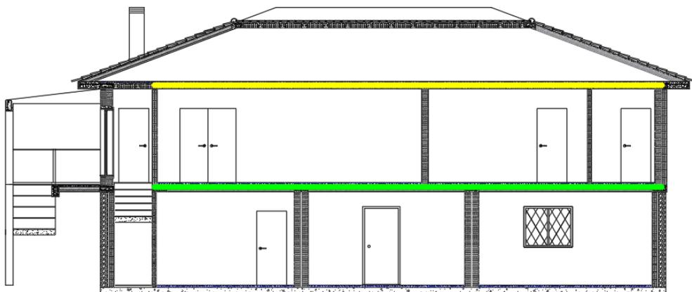
Figura 49 - Identificação de elementos horizontais da envolvente
