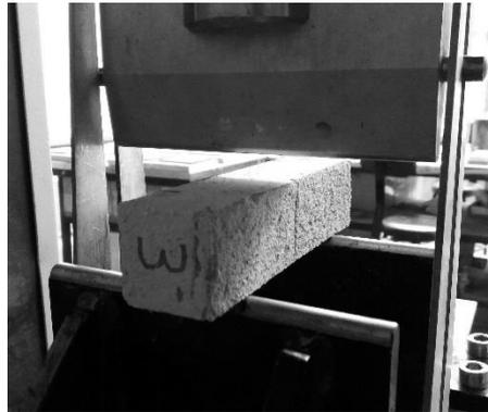
Figura 26 – Ensaio à flexão dos provetes de argamassa de junta.
