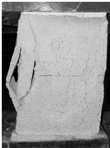
Figura 31 - Modo de rotura dos provetes de alvenaria.
