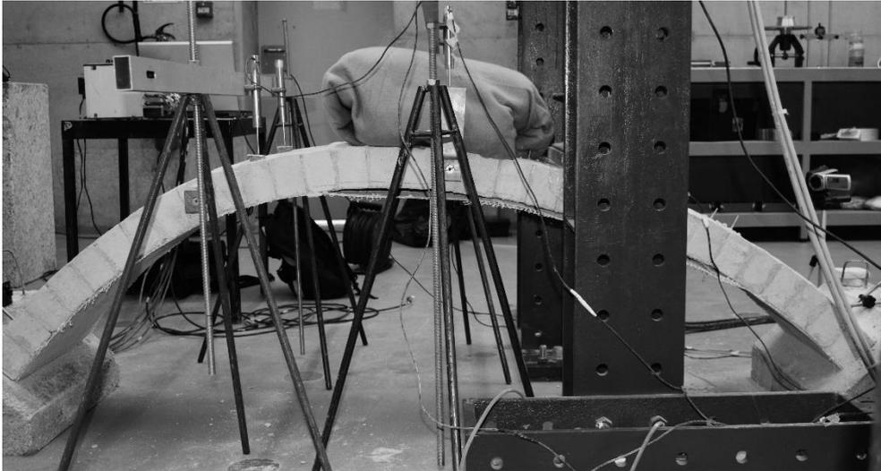
Figura 57 – Deformada de um do arco VSI3 em fase pré-colapso.
