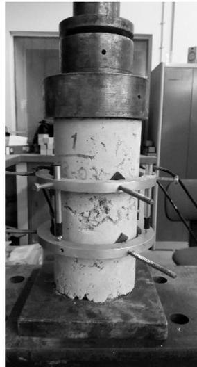
Figura 23 – Esquema do ensaio de compressão dos provetes de adobe.
