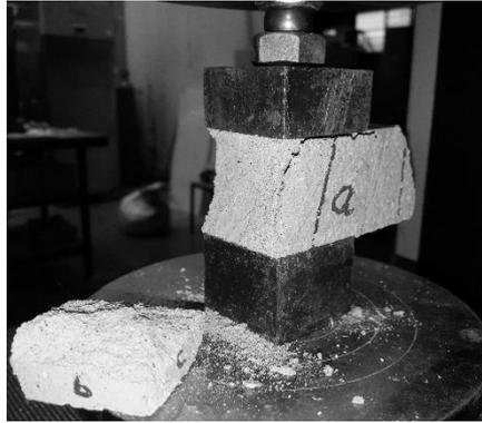
Figura 27 – Ensaio à compressão dos provetes de argamassa de junta.
