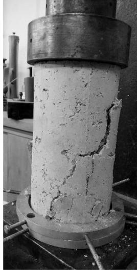
Figura 25 – Modo de rotura dos provetes de adobe.
