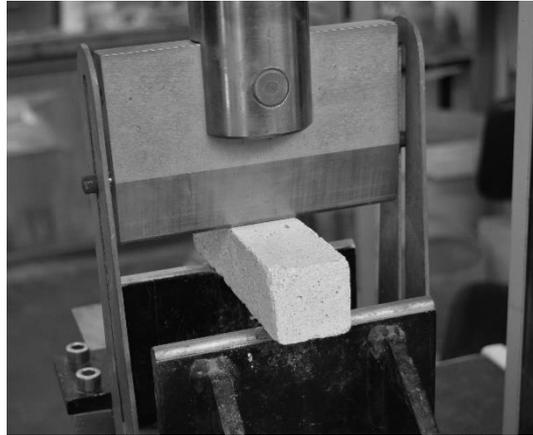
Figura 32 – Ensaio à flexão dos provetes de argamassa de reforço.
