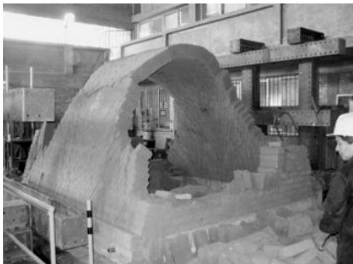
Figura 9 – Colapso de abóbada não reforçada
