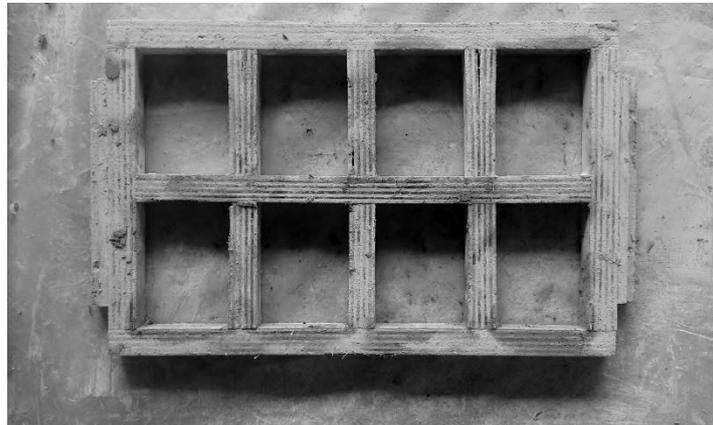
Figura 17 – Molde de madeira utilizado na produção dos adobes.
