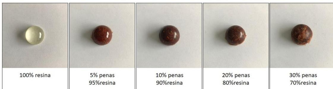
Figura 29. Compósitos com 0%, 5%, 10%, 20% e 30% de fibras (frente). Fonte: Autora, 2020.
