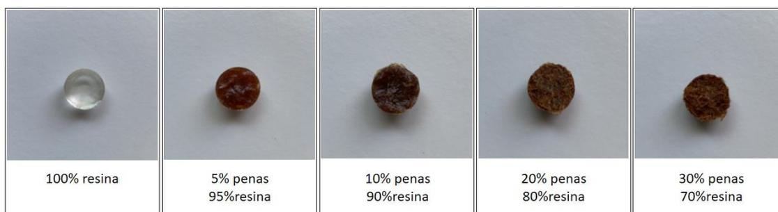
Figura 30. Compósitos com 0%, 5%, 10%, 20% e 30% de fibras (verso). Fonte: Autora, 2020.
