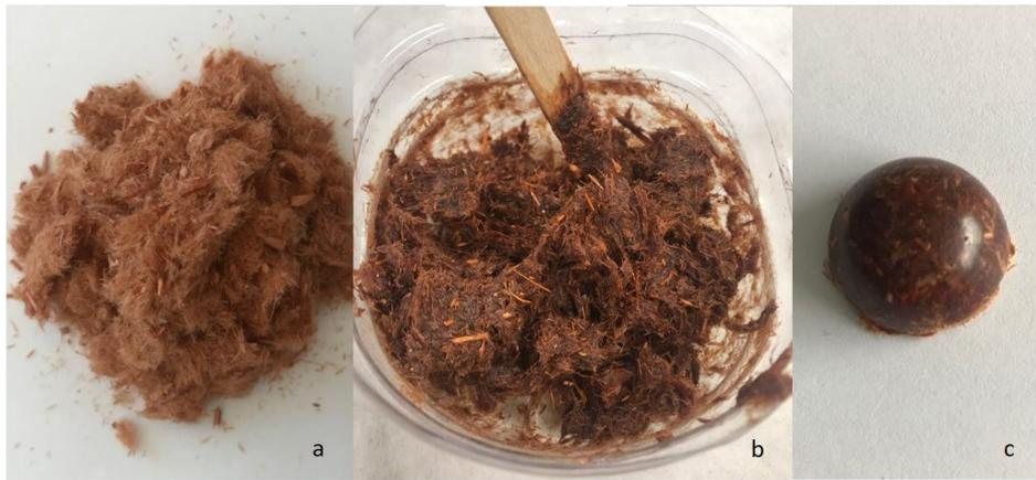
Figura 28. (a) fibras de penas tingidas com casca de cebola, (b) processo de impregnação das fibras pela resina e (C) compósito reforçado com fibras de penas tingidas após processo de cura. Fonte: Autora, 2020.
