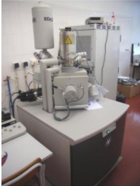
Figura 14. Microscópio eletrónico Nova NanoSEM 200. Fonte: <[http://www.semat.lab.uminho.pt/Equipamento\\_1.htm](http://www.semat.lab.uminho.pt/Equipamento_1.htm)> acessado em: 25 de agosto de 2020.
