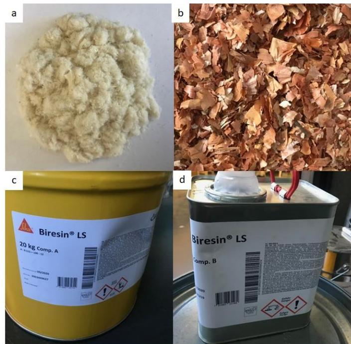
Figura 8. (a) amostra das fibras de penas de frango. (b) amostra das cascas de cebola trituradas. (c) lado A da da resina epóxida Biresin® LS da Sika®. (d) lado B da resina epóxida Biresin® LS da Sika®. Fonte: Autora, 2020.
