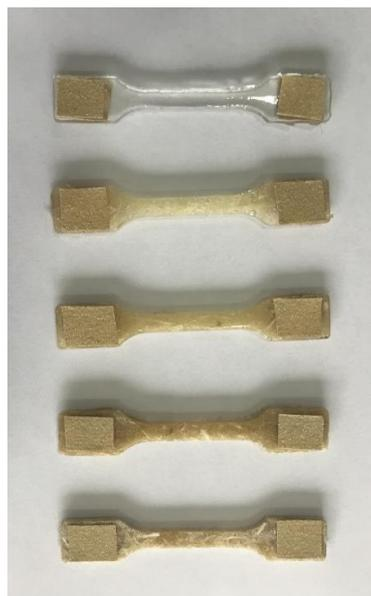
Figura 20. Amostras preparadas para o teste de tração. Fonte: Autora, 2020.
