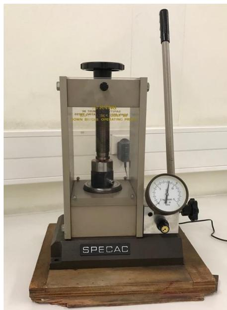
Figura 15. Compressor hidráulico Specac e molde de compressão de pastilhas. Fonte: Autora, 2020.
