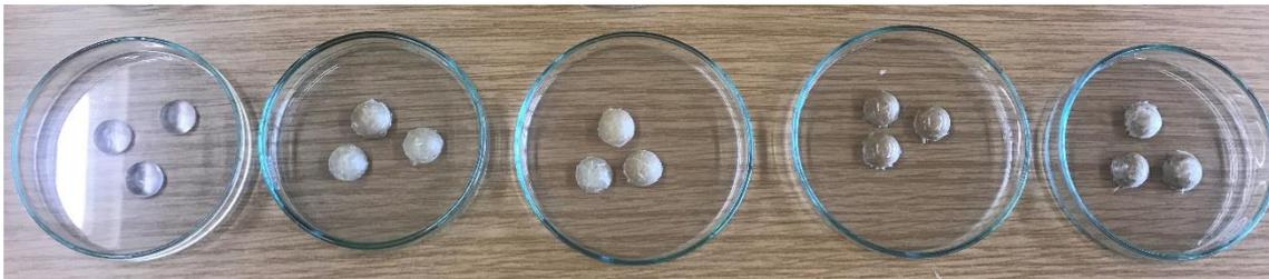
Figura 21. Amostras preparadas para o teste de absorção de líquido por imersão. Fonte: Autora, 2020.
