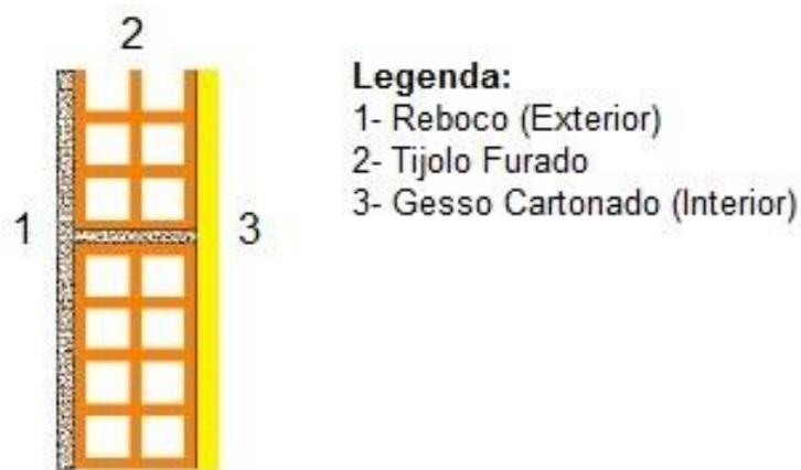
Figura 17: Pormenor construtivo das paredes exteriores
