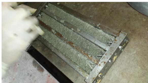
Figura 37 - Moldagem dos provetes
