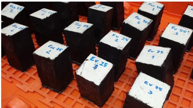
Figura 34 - Colocação dos provetes em água para ensaio de absorção por capilaridade
