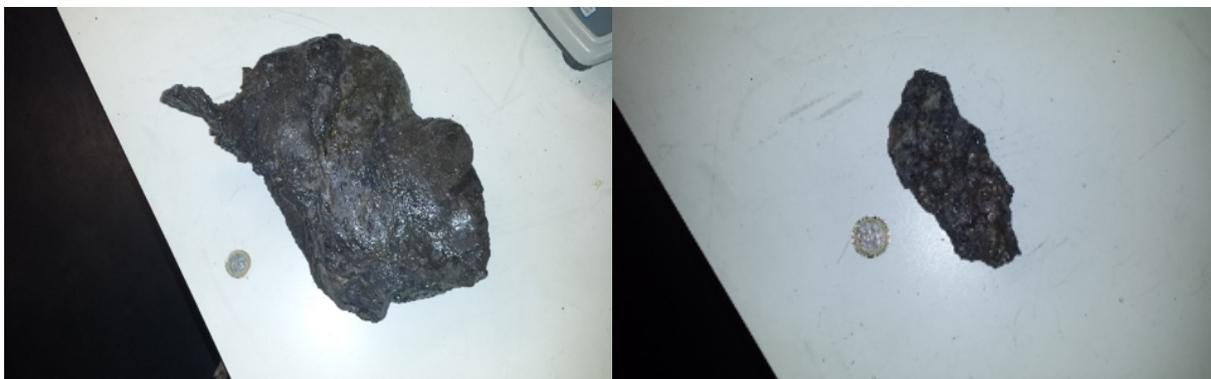
Figura 26 – Exemplo de fragmentos de escórias de fundição de ferrosos (Ece)
