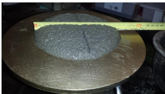
Figura 31 – Medição dos diâmetros em direções perpendiculares
