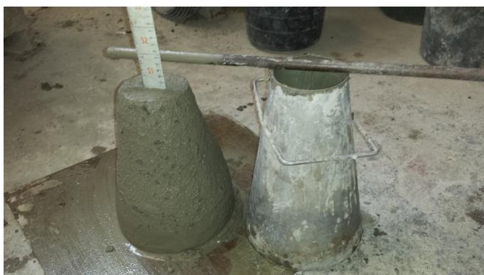
Figura 32 – Ensaio de abaixamento no Cone de Abrams
