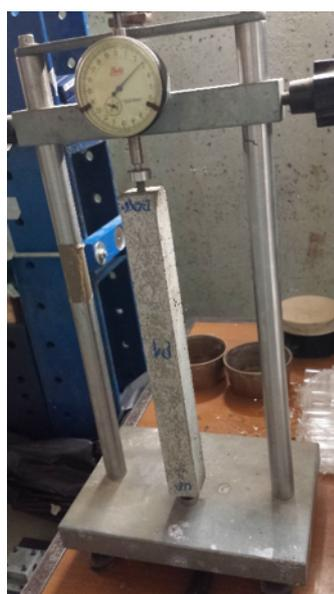
Figura 38 - Equipamento utilizado para medição da variação das extensões
