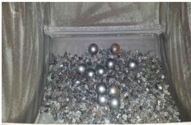
Figura 20 – Colocação da amostra no tambor juntamente com as esferas de aço
