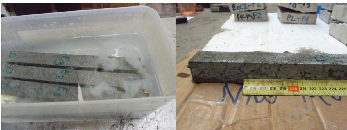
Figura 65 - Formação de gel na solução de NaOH (à direita) e fissuras nos provetes de argamassa com Ecc (à esquerda)
