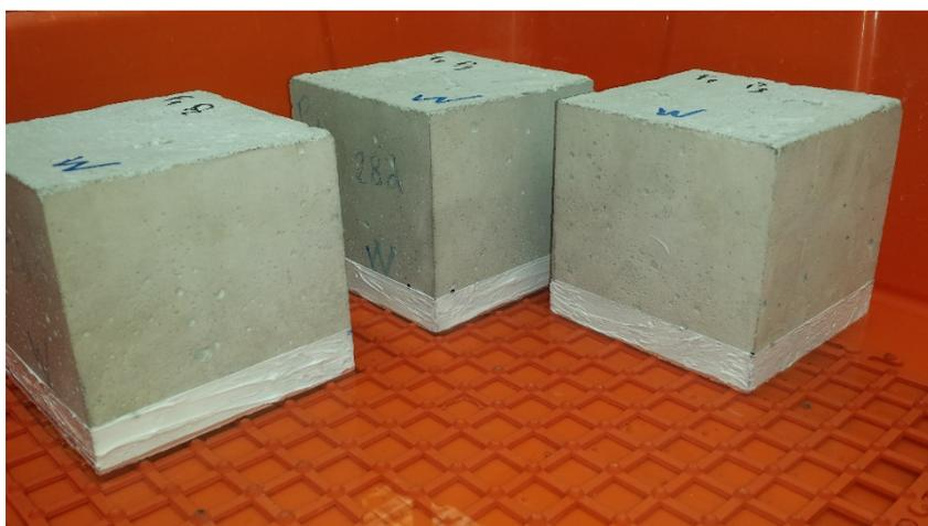
Figura 35 - Colocação dos provetes em água a uma profundidade de 5mm
