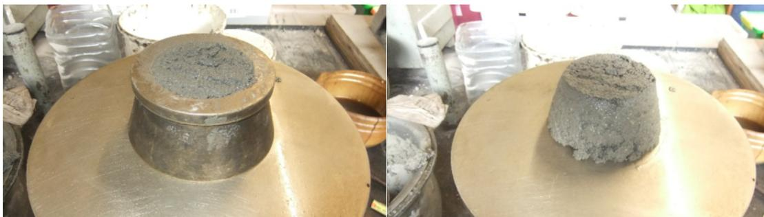
Figura 30 – Realização do ensaio de espalhamento
