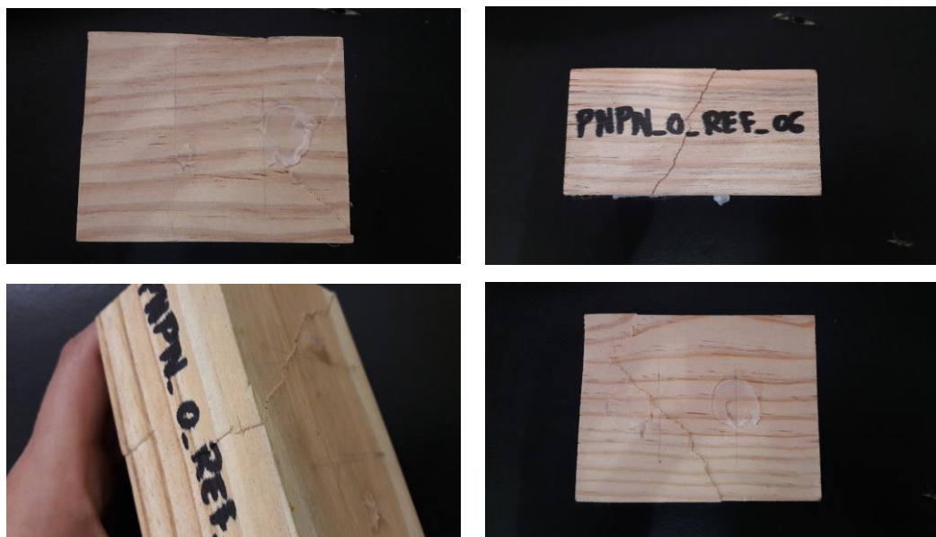
Figura 4.4 – Fotografias dos padrões de dano obtidos nos provetes pequenos de referência.
