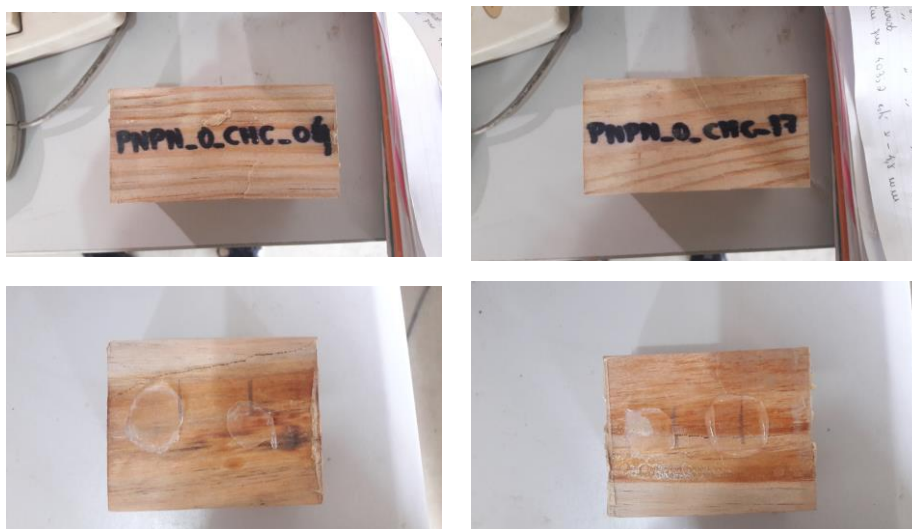
Figura 4.7 – Fotografias dos padrões de dano em provetes envelhecidos por ciclos de aspersão de água e secagem – CHU.
