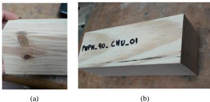
Figura 3.5 – Fotografias ilustrando os defeitos encontrados em alguns provetes durante a inspeção inicial: (a) fotografia do provete 90_CHL_10 com 3 nós; (b) fotografia do provete 90_CHU_01 com uma fenda.
