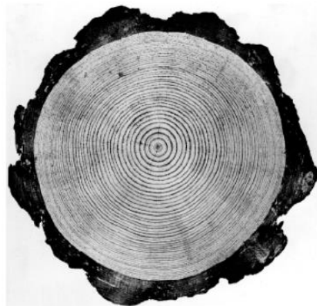
Figura 2.6 – Corte transversal de um tronco onde são visíveis os anéis de crescimento (Forest Products Laboratory, 1999).
