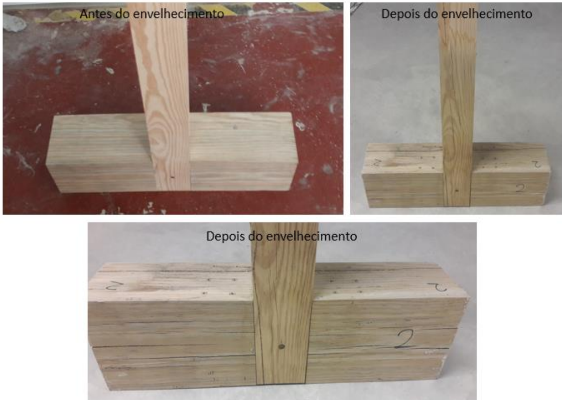
Figura 3.31 - Comparação da ligação 2 antes e após o envelhecimento CHU.
