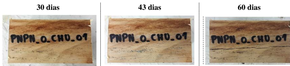
Figura 3.27 - Fotografias do envelhecimento do provete 0_CHU_01 submetido ao tipo de envelhecimento CHU.
