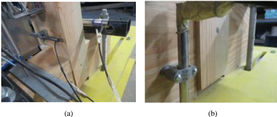
Figura 5.6 - Movimento da ligação durante o ensaio pull-out : (a) movimento ascendente da ligação; (b) deslocamento para fora do plano.
