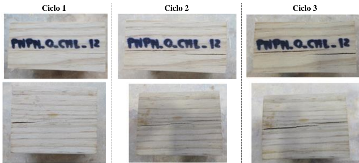
Figura 3.20 - Fotografias do envelhecimento acelerado CHL durante 12 ciclos.
