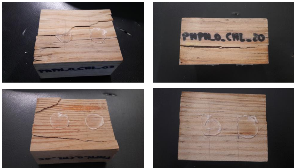
Figura 4.6 –. Fotografias dos padrões de dano em provetes, envelhecidos por ciclos de molhagem e secagem durante 6 e 12 ciclos, após os ensaios de compressão uniaxial.
