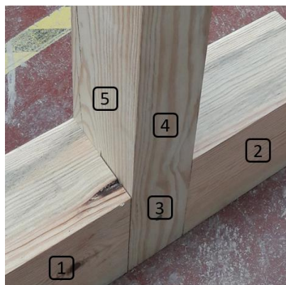
Figura 3.38 - Esquema dos pontos onde foi retirada a velocidade de ondas ultrassom.
