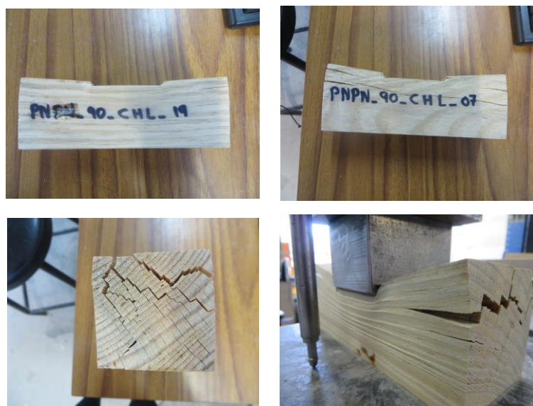
Figura 4.19 –. Fotografias dos padrões de danos em provetes pequenos envelhecidos por ciclos de imersão e secagem.
