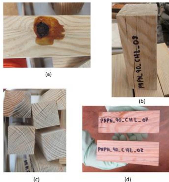
Figura 3.18 – Fotografias dos diferentes tipos de degradação detetadas após o primeiro ciclo de envelhecimento acelerado CHL. (a) Saída de resina; (b) e (c) fissuras; (d) instabilidade dimensional.
