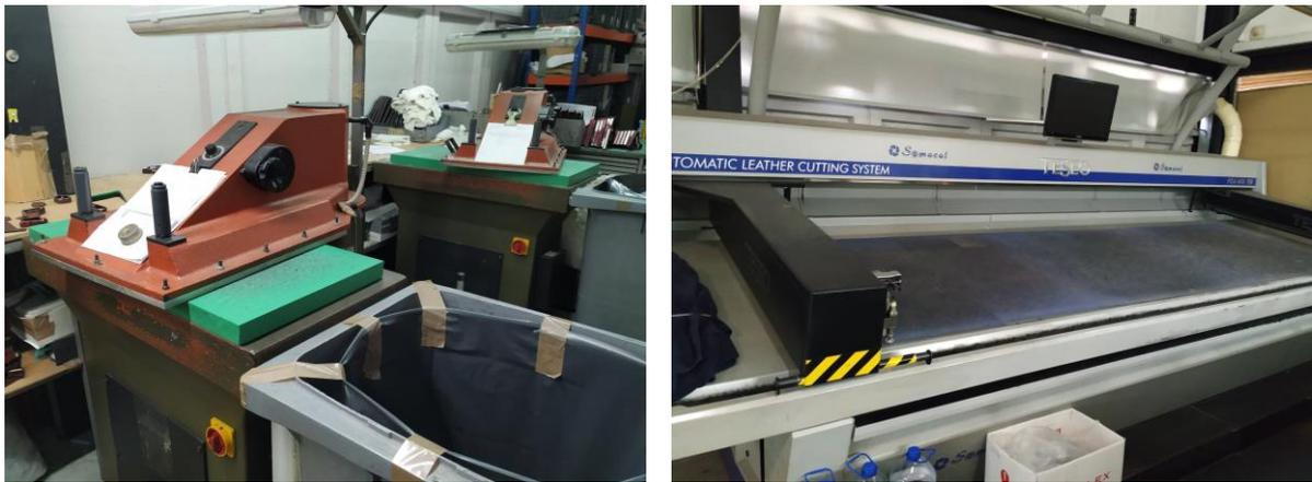
Figura 9: Máquina de corte manual (esquerda) e máquina de corte automático (à direita)
