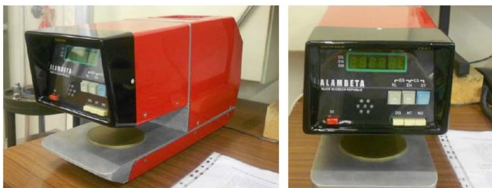
Figura 18: Equipamento Alambeta , para avaliação das propriedades térmicas de substratos têxteis.
