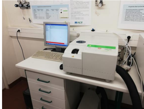
Figura 13: Instrumento DSC , utilizado para caracterização térmica das amostras.
