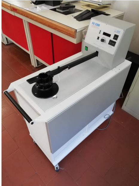
Figura 30: Permeabilímetro ao ar Textest 5110 Labdata .
