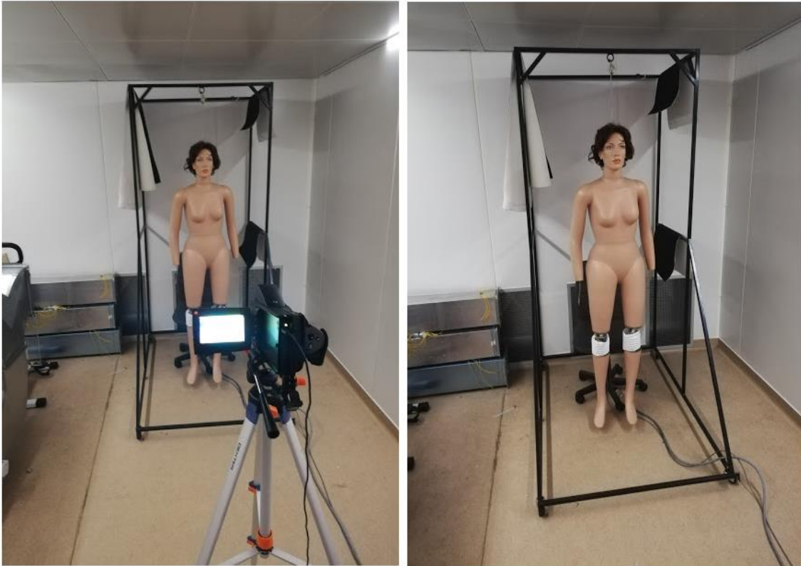
Figura 19: Manequim e câmara térmica utilizados neste ensaio.
