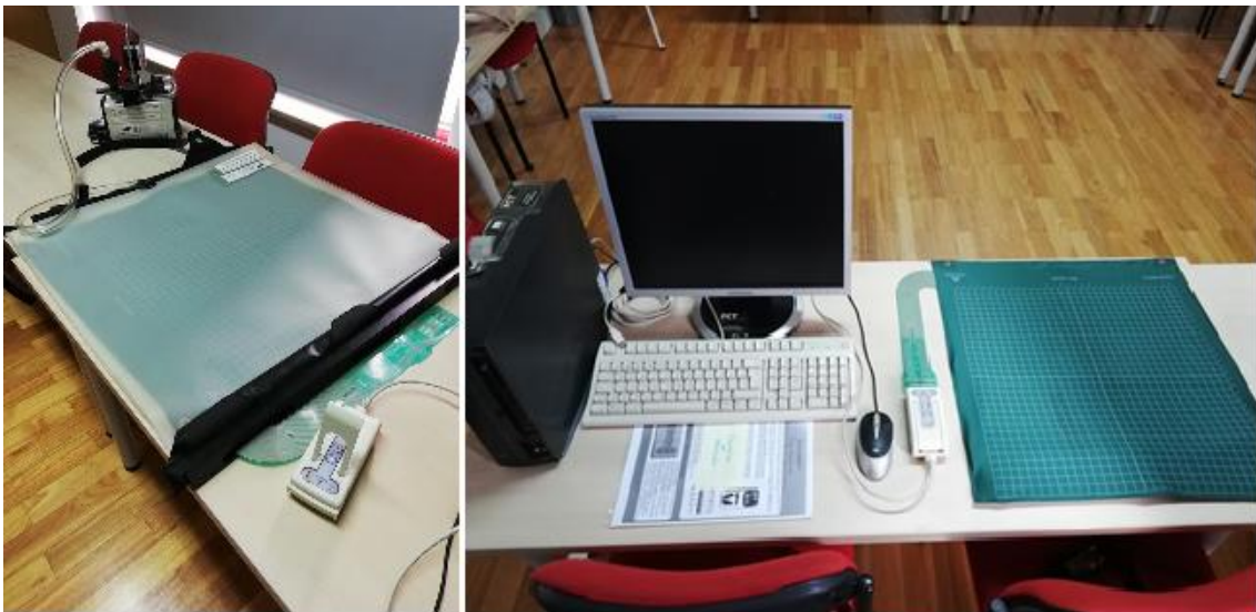
Figura 15: Equipamento de medição de pressão piezoresistivo Tekscan's Conformat : esq. Preparação da calibragem; dir. set up de medição da pressão.
