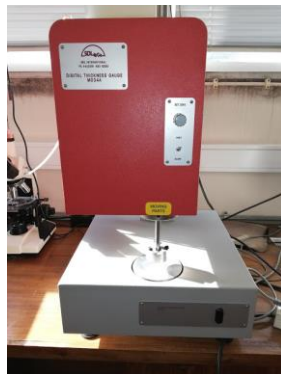
Figura 17: Medidor de espessura digital M034 da SDL Atlas.
