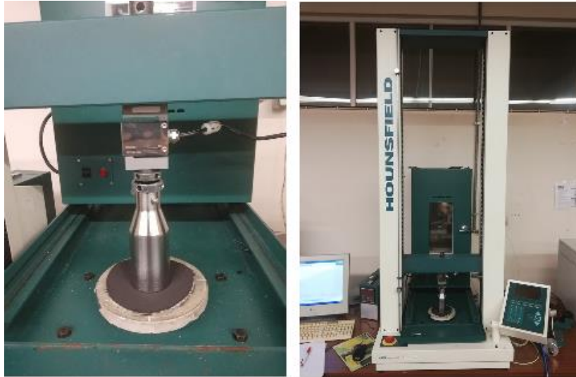
Figura 26: Set-up para os ensaios de compressão: (esq.) célula de carga e impactador; (dir.) máquina universal de teste Hounsfield H100KS.
