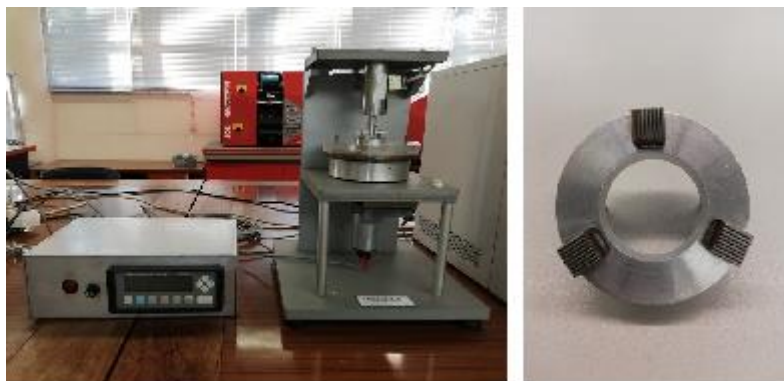
Figura 24: Equipamento Frictorq (esq.); sensor binário reativo de precisão (dir.)
