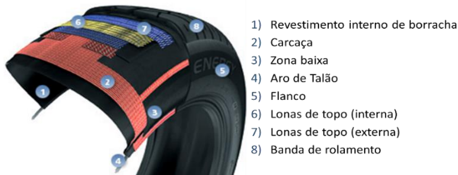
Figura 7: Estrutura de um pneu, adaptado de (Michelin Portugal, 2018).
