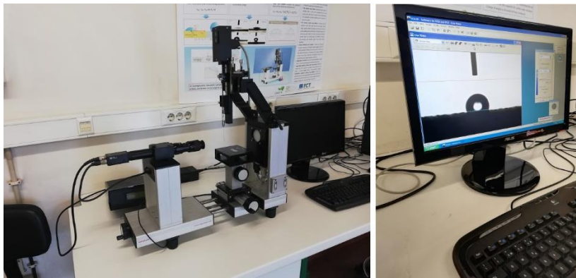
Figura 34: Set-up de medição do ângulo de contacto: esq. goniómetro; dir. software de gravação e medição do ângulo formado entre a gota e a superfície.
