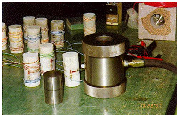
Figura 14: Câmara triaxial dimensionada para suportar tensões de confinamento de 50 MPa.
