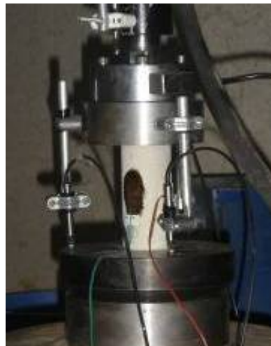
Figura 7: Determinação do módulo de elasticidade com extensômetros elétricos e LVDT's.
