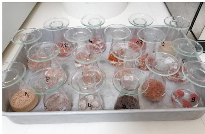
Figura 7: Amostras contidas no matraz com 30 mL de ácido sulfúrico 3 M prontas para irem 16 horas à estufa a  $105 \text{ }^\circ\text{C}$
