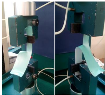
Figura 25 -Dinamómetro, Resistência ao teste de rasgo pelo método “ASA”
