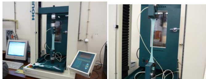
Figura 24 – Dinamómetro, Resistência ao teste de Tração pelo método da tira.
