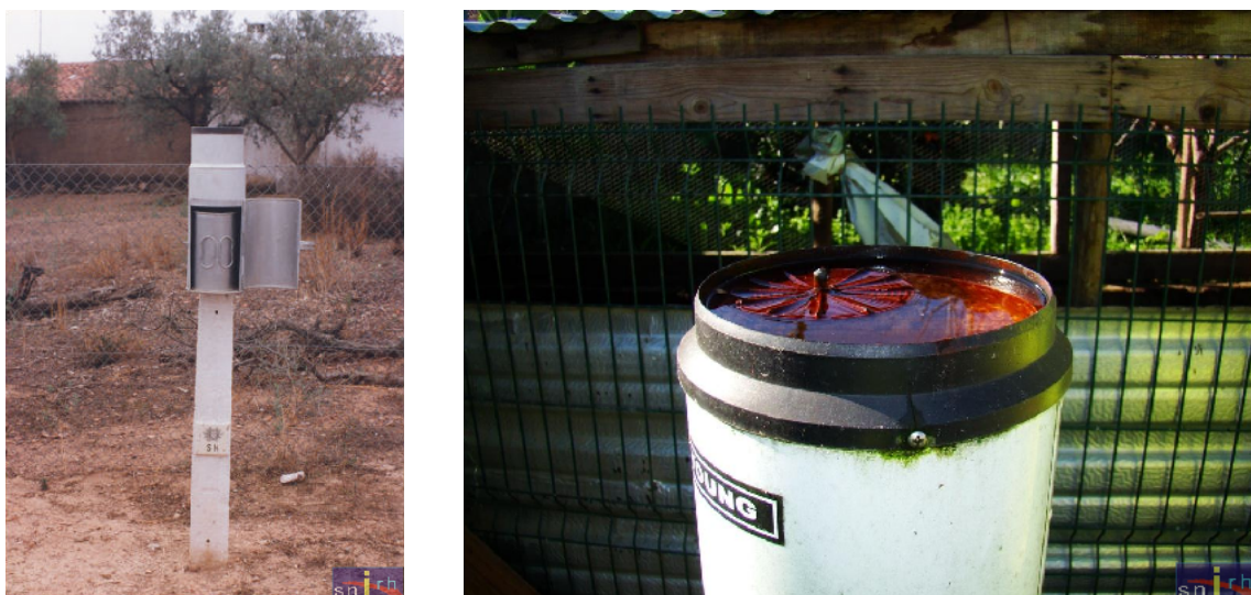
Figura 5.3: Esquerda: Udómetro, utilizado para medir a precipitação total que caiu num determinado período de tempo, 28 de setembro de 1992, em Vale dos Camelos (DSRH/I-NAG). Direita: Udómetro entupido e com água acumulada da Estação Automática sem telemetria, 28 de dezembro de 2012, em Laranjal, Ponte Sôr (DMSDIH/APA).
