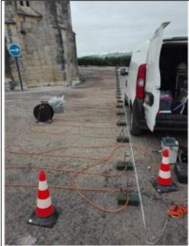
Figura 13: Perfil de resistividade elétrica na face voltada a Este do Local
