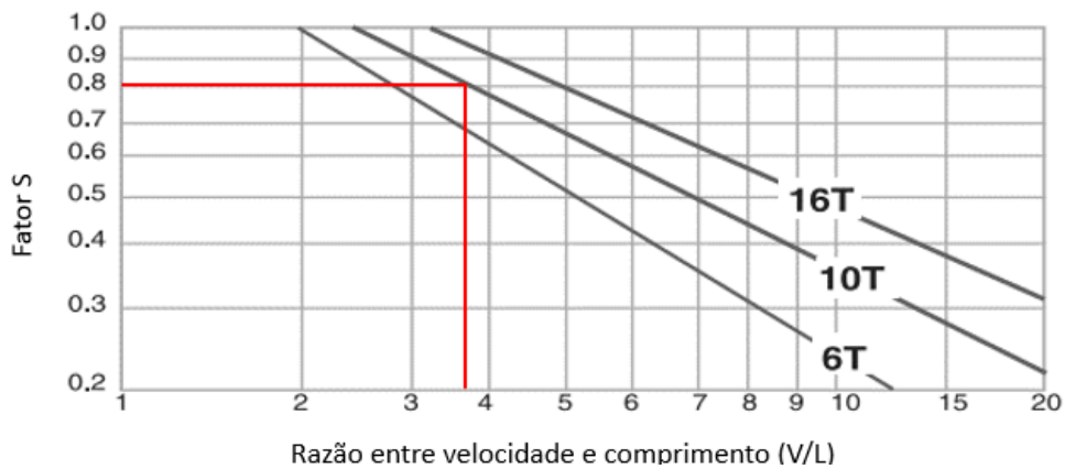
Figura 120 - Fator S em função do número de dentes da engrenagem e da razão entre velocidade e comprimento do tapete rolante. Adaptado de ( Intralox , 2019).
