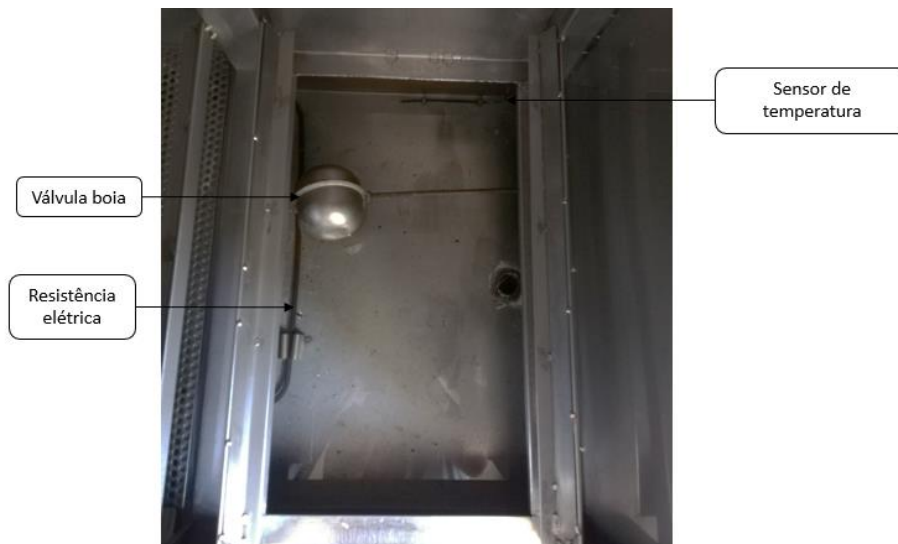
Figura 29 - Depósito da câmara de humificação 1 e respetivos componentes constituintes.
