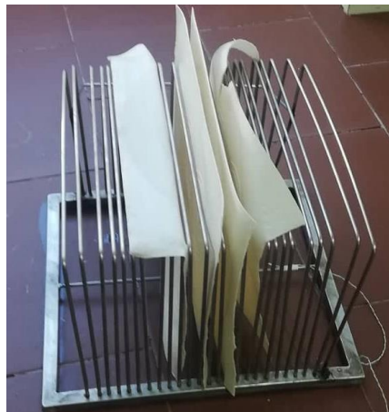
Figura 37 - Alteração geométrica provocada nas placas após o processo de humedificação.
