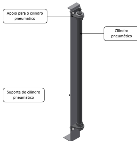
Figura 94 - Cilindro pneumático fixo ao suporte de ligação à camara de humidificação.
