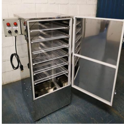
Figura 24 - Câmara de humidificação da Maq Company ( Maq Company , s.d.).
