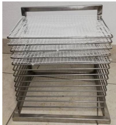
Figura 34 - Suportes para a introdução de placas na horizontal.
