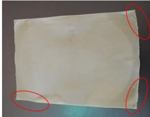
Figura 36 - Alterações geométricas resultantes de uma temperatura de humidificação excessiva.
