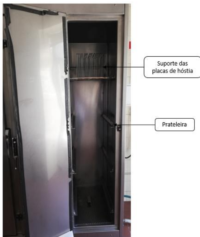
Figura 28 - Colocação dos suportes das placas nas prateleiras da câmara.
