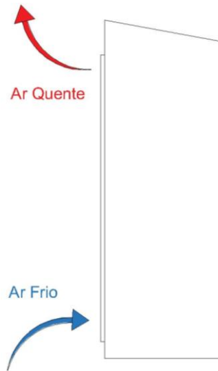
Figura 40 - Esquema da entrada e saída de ar, com a abertura de portas.
