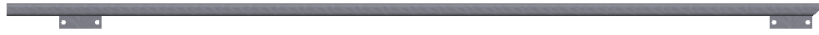
Figura 68 - Demonstração do corte nas extremidades das guias de desgaste junto aos eixos de rotação.
