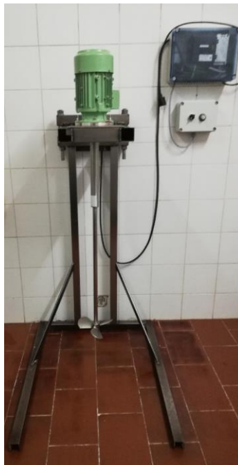
Figura 16 - Bateadeira industrial utilizada na produção de massa.
