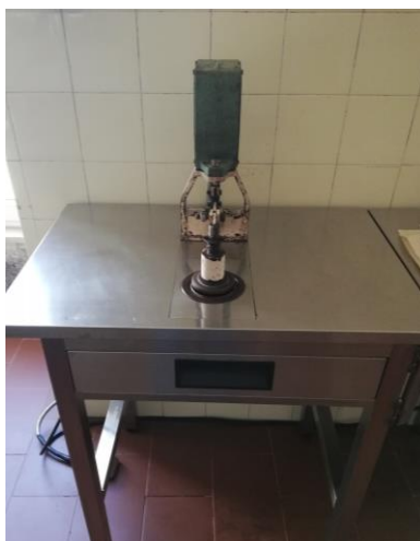
Figura 23 - Equipamento de corte de hóstias de 8 cm.
