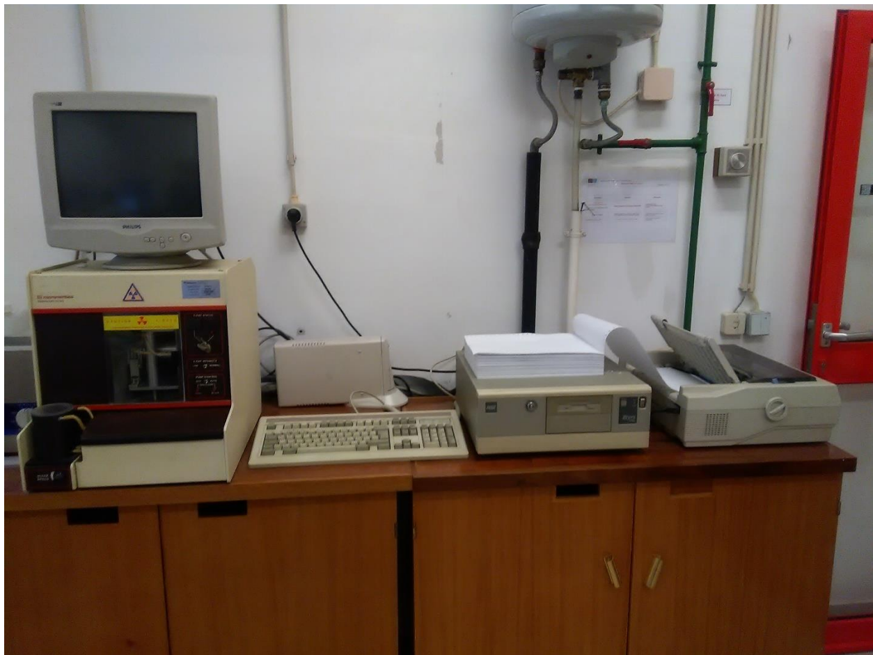
Figura 16: SediGraph e seus acessórios do Laboratório de Sedimentologia e Lâminas Delgadas da Universidade do Minho. Fonte: Autor, Abril de 2019.
