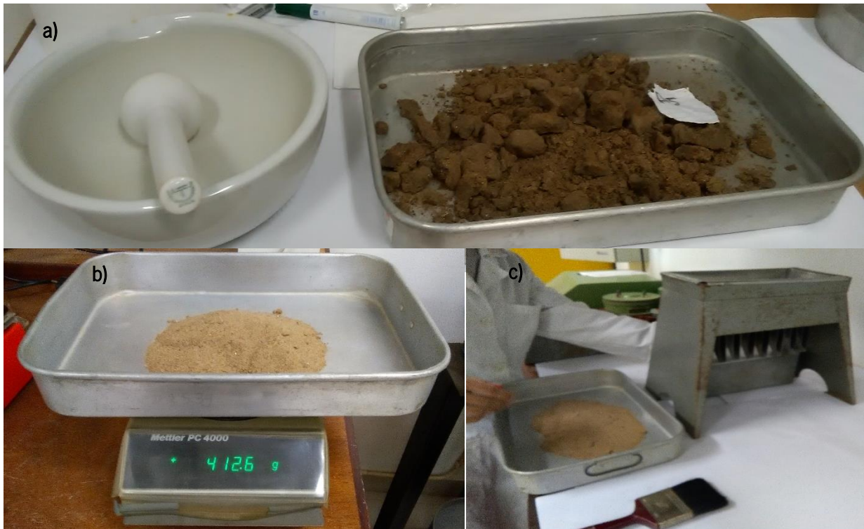
Figura 13: Imagens representativas do processo de quartilha. a) Uso de almofariz para destorroamento de amostras mais compactadas. b) Processo de pesagem das amostras. c) Quartilhador mecânico.
