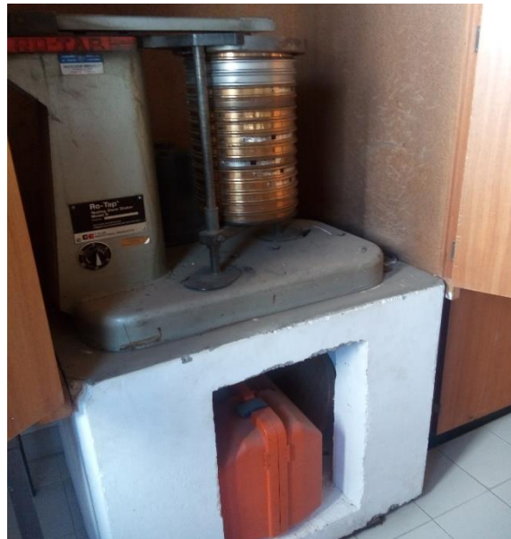
Figura 15: Conjunto de crivos e o agitador de crivos utilizado para a análise granulométrica dos sedimentos. Fonte: Autor, Janeiro de 2019.
