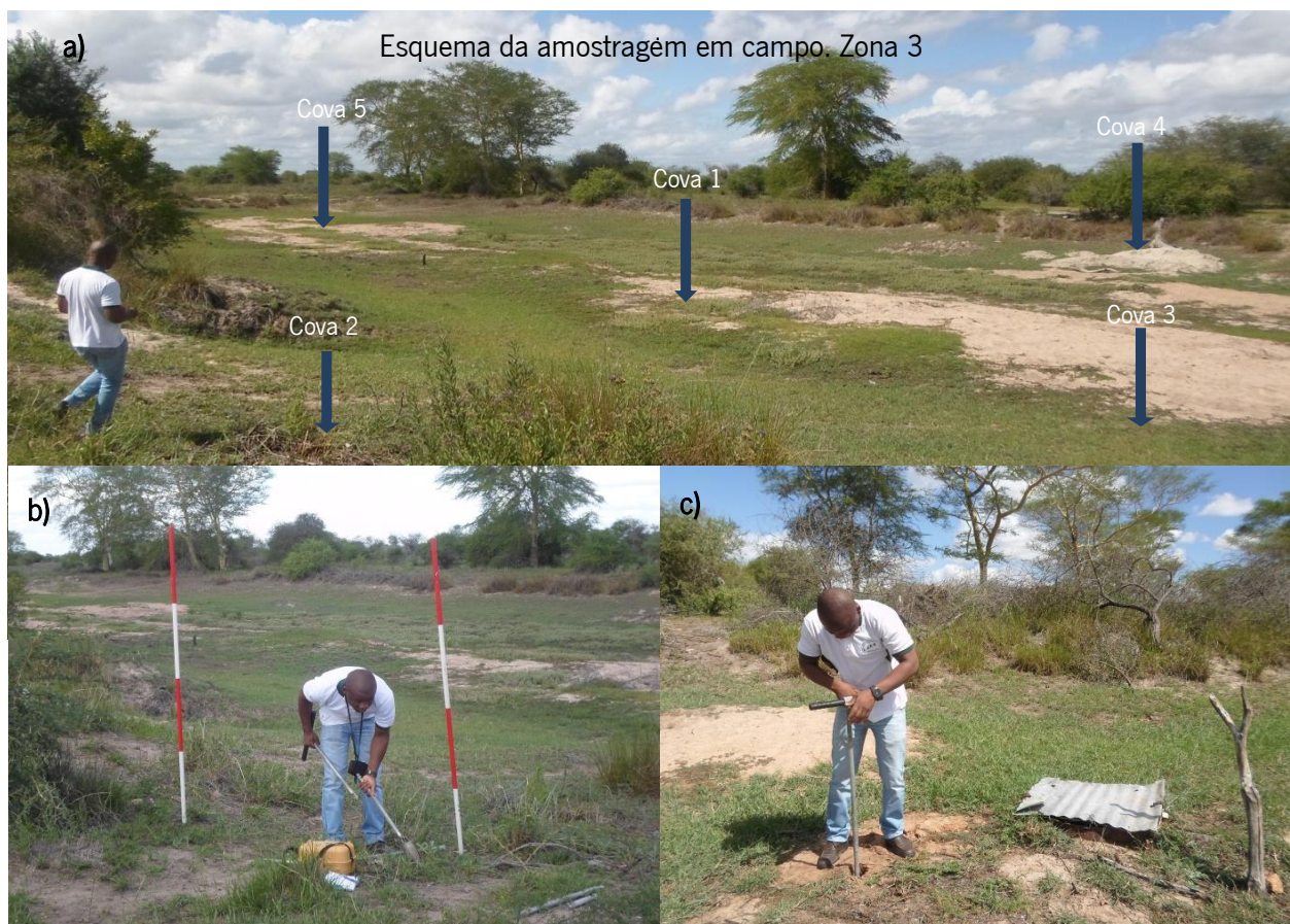
Figura 8: Imagens identificativas e representativas dos locais onde foram retiradas as amostras. a) Dispositivo de infiltração e drenagem da Zona 3. b) Preparação do material de campo para o início da recolha das amostras. c) Recolha de amostra com auxílio de trado. A junção dos sedimentos das covas 1 a 5 resultou em uma única amostra.
