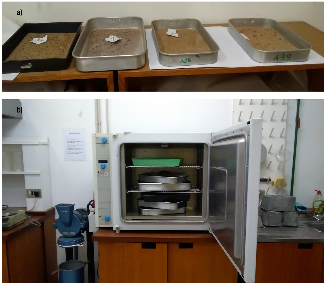
Figura 12: Imagens representativas da preparação e secagem das amostras no Laboratório de Sedimentologia da Universidade do Minho. a) Amostras em bandejas previamente identificadas. b) Amostras em estufa ventilada.
