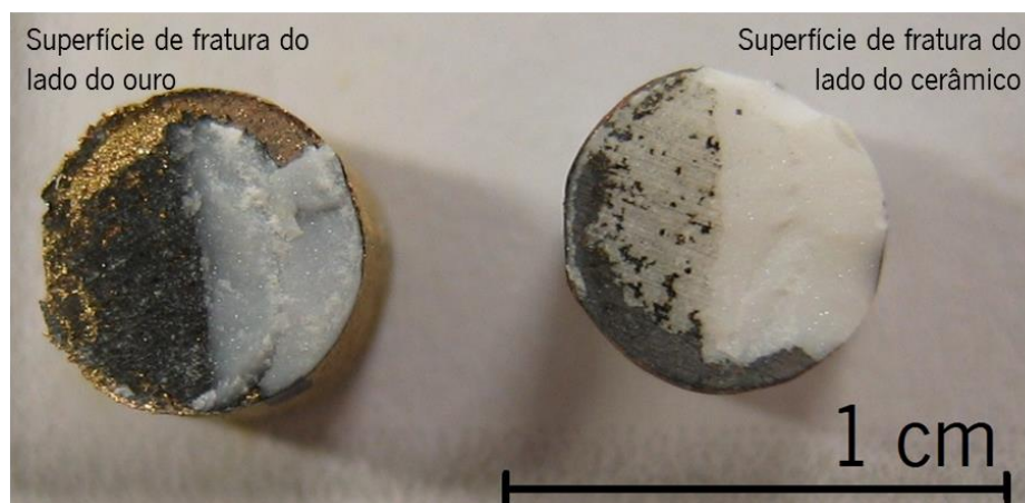
Figura 35 – Macrografia representativa das superfícies de fratura.
