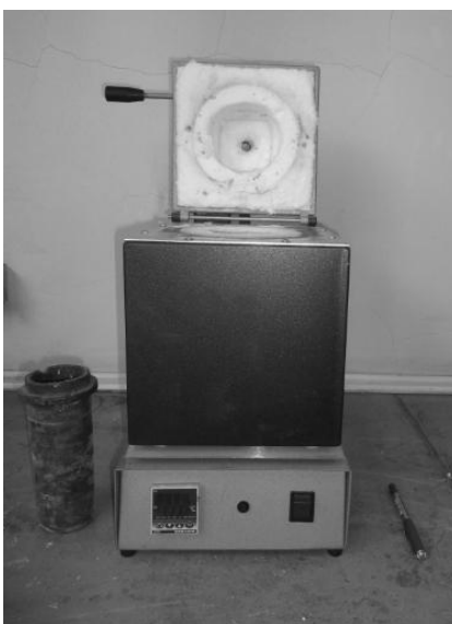
Fig. 3.1 – Forno de resistências utilizado na fusão da liga AlSi9Cu3(Fe).
